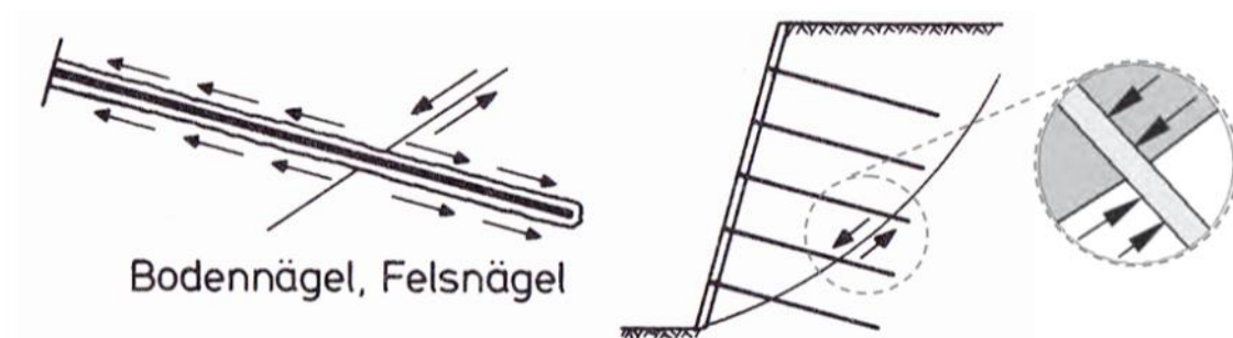
Abb. 1 Beanspruchung des Nagels (Marte & Supp, 2014)
