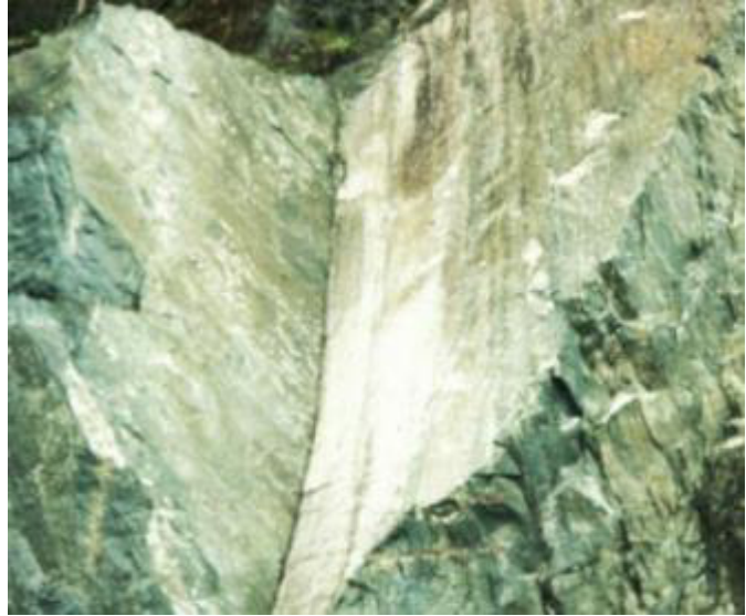
ABBILDUNG 9 KEILVERSAGEN. A DAS MODELL, B EIN PRAKTISCHES BEISPIEL (KIEFFER, 2014)
