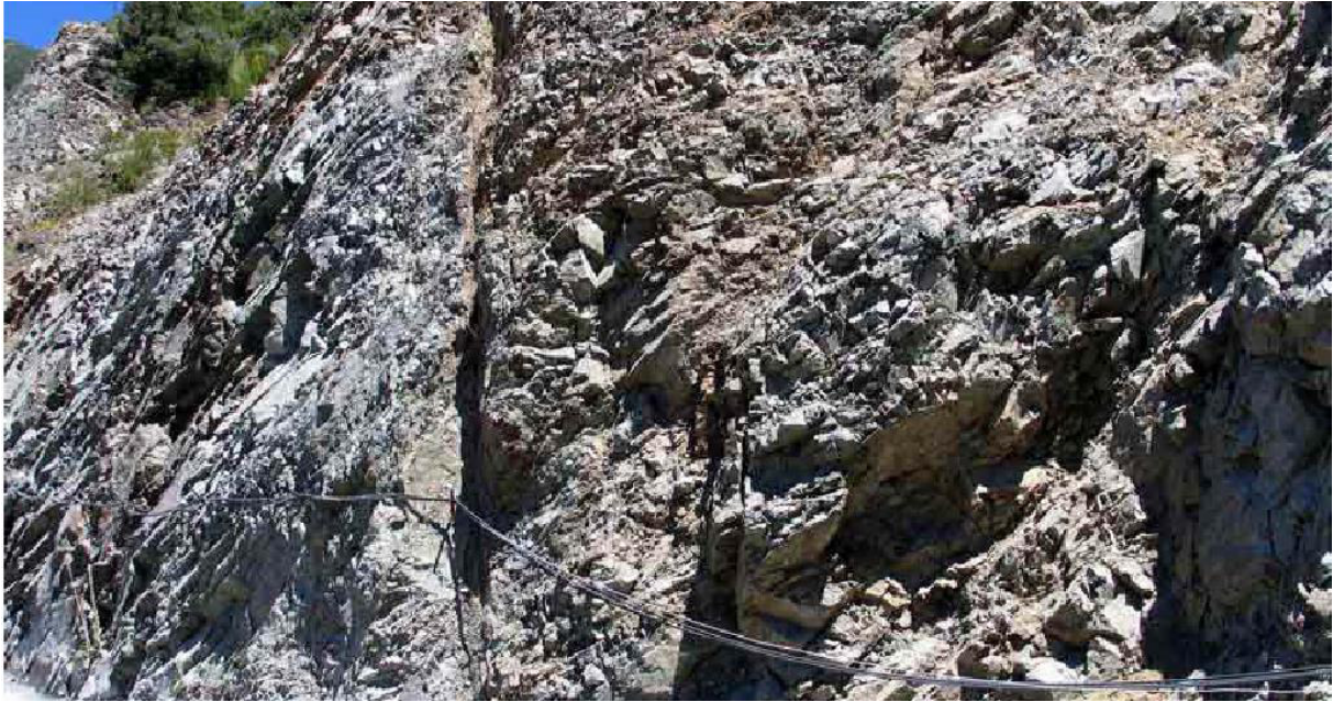
ABBILDUNG 3 UNREGELMÄBIGE KLUFTSCHAREN SCHWER ZU BESTIMMEN, A. PALMSTRÖM BLOCK SIZE AND SHAPE 2005
