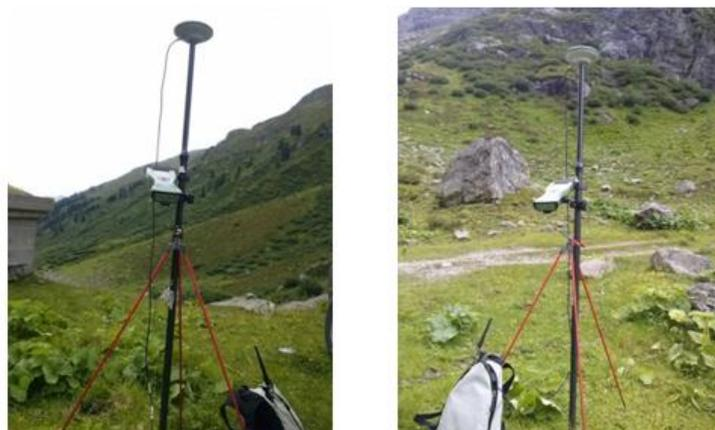
Abbildung 7.8 Der GNSS Messprozess, Instrument gefestigt durch die Lotstabbefester
