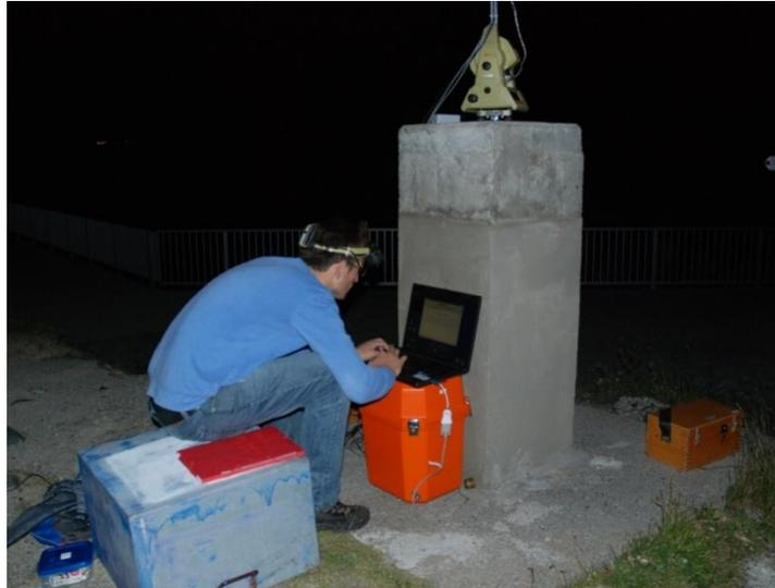
Abbildung 7.24 Die Messung der Sternposition auf dem Pfeiler am Silvrettasee
