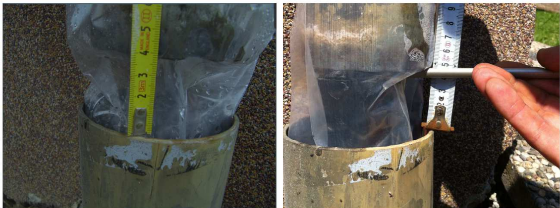
Abbildung 6-14 – Zugöffnung bei der Einleitung der Regenrinne in den Regenwasserableitungsschacht: 38 mm am 18.06.2013 - 47 mm am 19.06.2013 252
