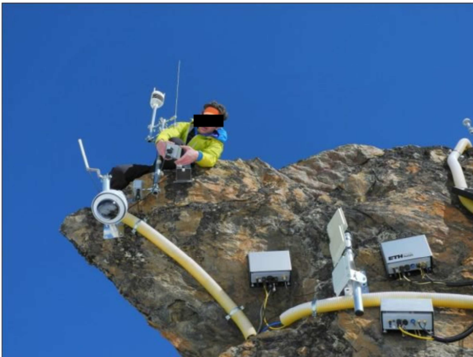
Abbildung 2-25 – GPS-Messstation an einem Felsvorsprung 106
