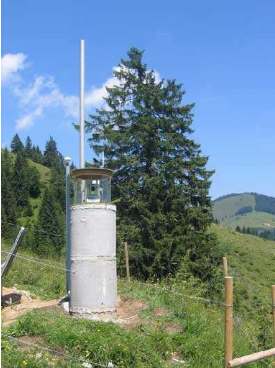
Abbildung 2-24 – Videotachymeter zur Überwachung der Hangbewegung 105
