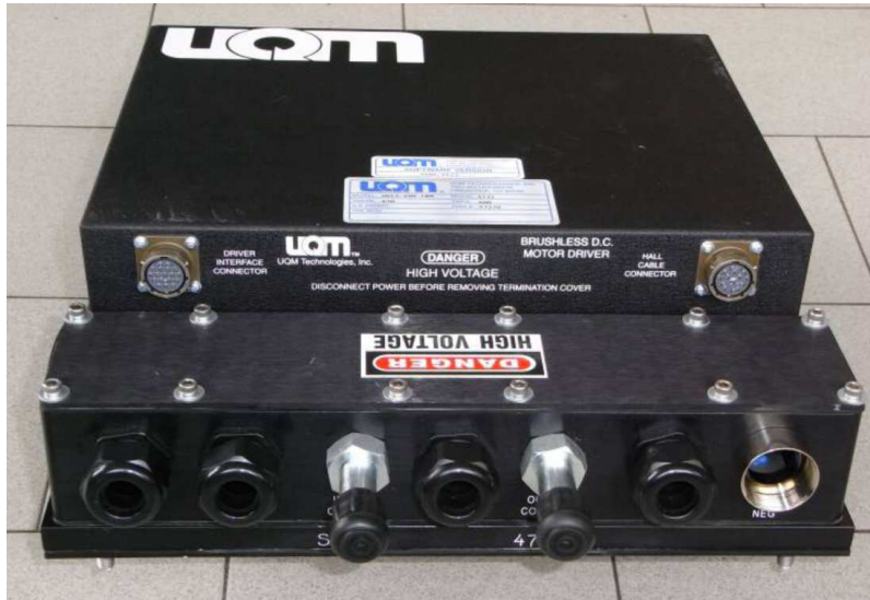
Abbildung 1.3.: UQM Leistungselektronik zur Wandlung der von der HV Batterie zur Verfügung gestellten Gleichspannung in eine vom Elektromotor benötigte Wechselspannung. Entnommen aus [16]
