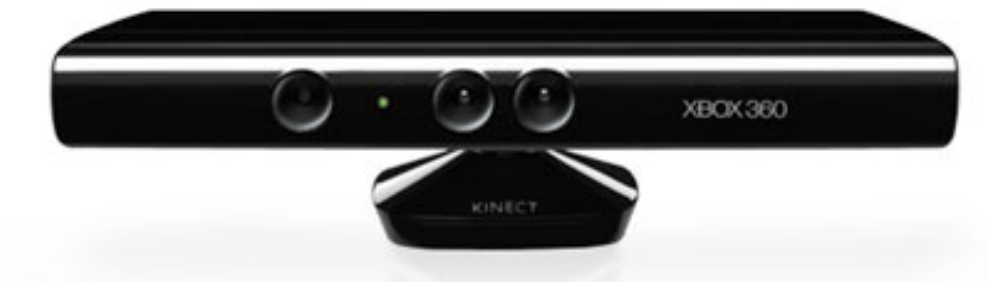
Abbildung 2.4: Die Microsoft-Kinect-Tiefenkamera zur Motion-Steuerung der Xbox 360
