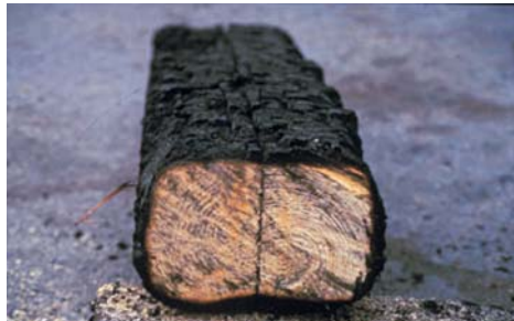
Abb. 4.7 Holz nach Brandeinwirkung
