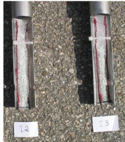
Abb. 11: Befestigungsstutzen für „In Sacco“-Gewebe mit Migulator zur Positionierung in den Bioreaktoren I2 und I3 (nach Andrade und Lebuhn, 2009)
