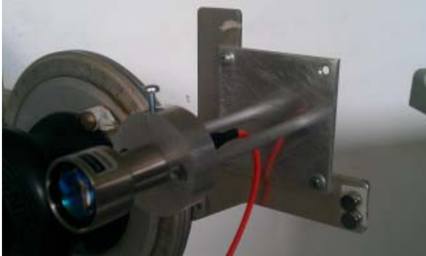
Abbildung 27: Montagevorrichtung des Kollimators
