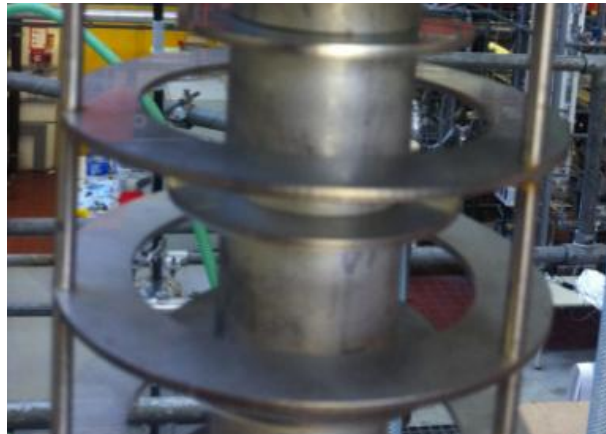
Abbildung 3-6: Fertigungstoleranzen, nicht ideale Abstände Rotor-Stator
