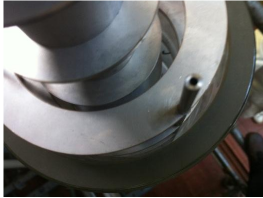
Abbildung 3-4: Spalt zwischen Glasschuss und Statorscheiben
