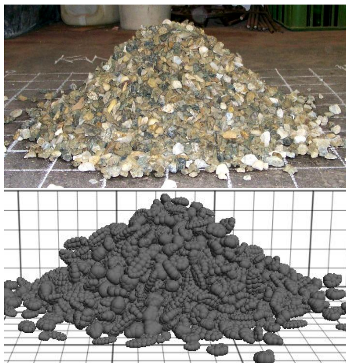
Abbildung 38: Endergebnis eines Aufschüttversuches verglichen mit dem Laborversuch
