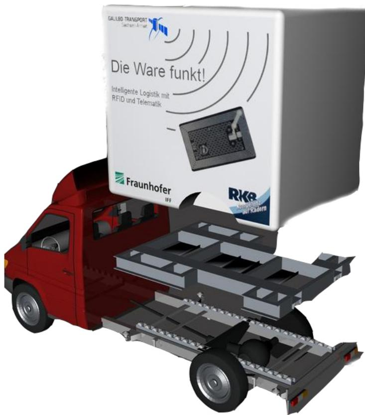
**Abbildung 5-5** Wechselbehälter für den Einsatz von Elektromobilität in der City-Logistik
