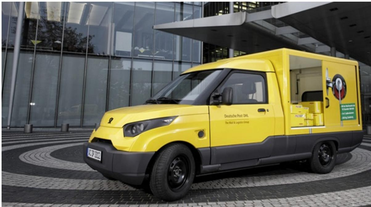
**Abbildung 3-23 Elektro-Nutzfahrzeug Streetscooter**
