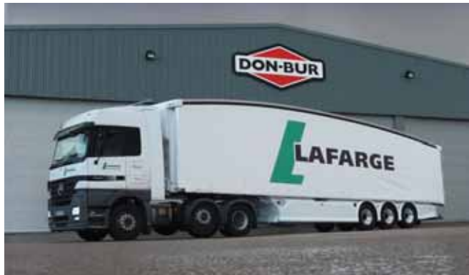
Abbildung 1.1: Aerodynamisch günstiger Auflieger [5]
