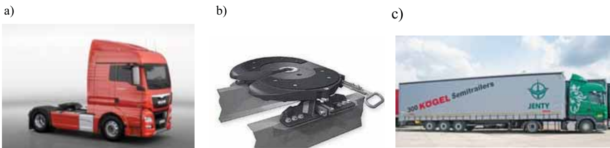
Abbildung 2.1: Bild a) zeigt eine Sattelzugmaschine [12], b) Sattelkupplung [13], c) Standard-Sattelaufleger [14]
