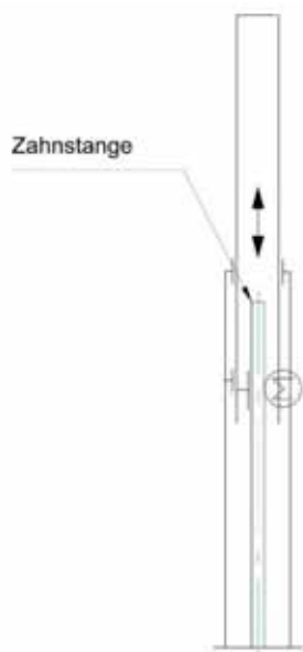
Abbildung 6.5: Lösungsprinzip A.3 zeigt eine Runge mit Zahnstange, A.4, A.5 zeigen je eine Runge mit Seilzug
