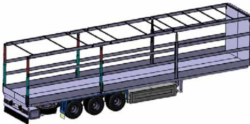
Abbildung 3.3: Vorentwurf eines vertikalen Einzugs, dargestellt im ausgefahrenen Zustand [27]
