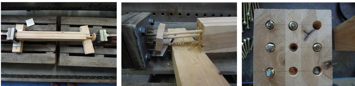
Abbildung 5.8: Bilder des Versagens des Prüfkörpers T005\_1 auf Schraubenbruch und Ausziehen
