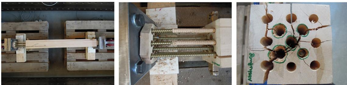
Abbildung 5.31: Bilder des Versagens des Prüfkörpers T003\_2 durch Aufspalten
