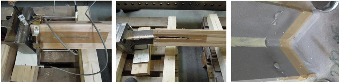
Abbildung 5.39: Bilder des Versagens des Prüfkörpers T004\_3 durch Versagen der Klebstofffuge
