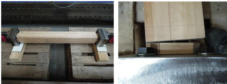
Abbildung 5.28: Bilder des Versagens des Prüfkörpers T002\_2 durch Herausziehen der Schrauben (Prüfung 8.1)
