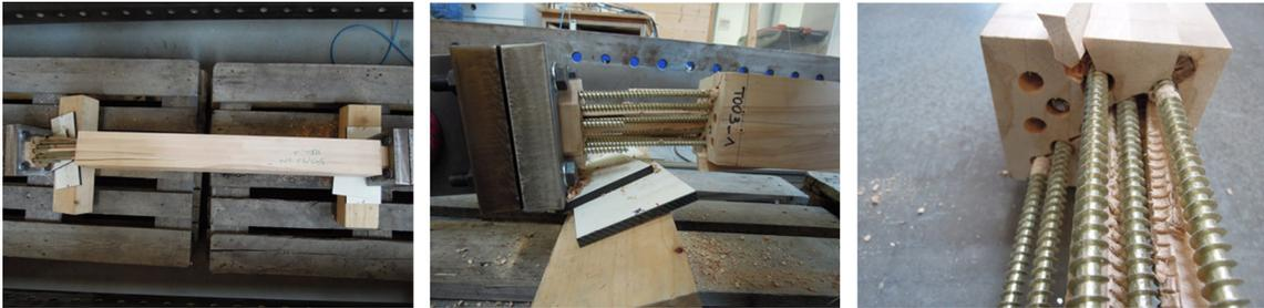
Abbildung 5.18: Bilder des Versagens des Prüfkörpers T003\_1 durch Aufspalten und Schraubenbruch
