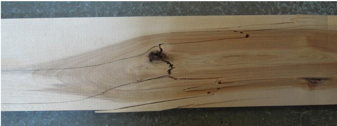
Abbildung 4.6: Bruch infolge eines Astes mit Rindeneinschluss
