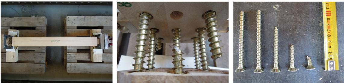
Abbildung 5.26: Bilder des Versagens des Prüfkörpers T003\_3 auf Schraubenbruch und Ausziehen
