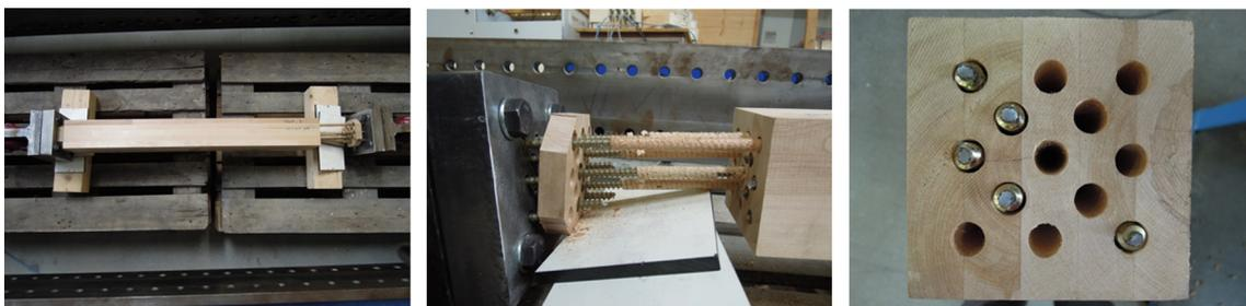
Abbildung 5.12: Bilder des Versagens des Prüfkörpers T005\_3 auf Schraubenbruch und Ausziehen
