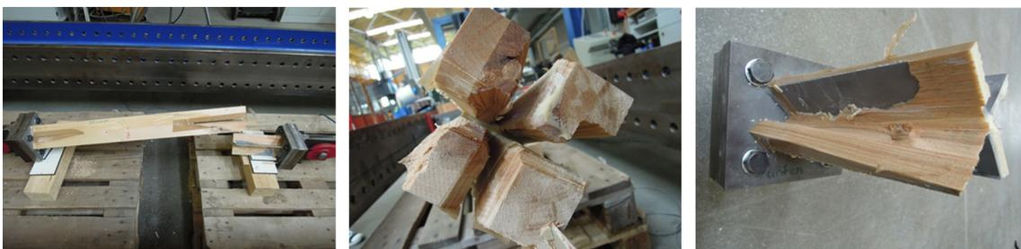
Abbildung 5.36: Bilder des Versagens des Prüfkörpers T001\_3 durch Versagen der Klebstofffuge
