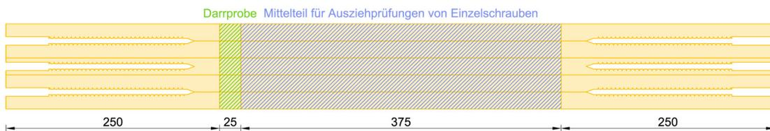
Abbildung 4.20: Entnahme der Darrproben und des mittleren Prüfkörperteils
