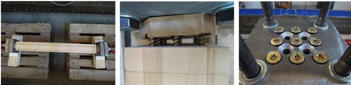
Abbildung 5.24: Bilder des Versagens des Prüfkörpers T004\_2 durch Herausziehen der Schrauben
