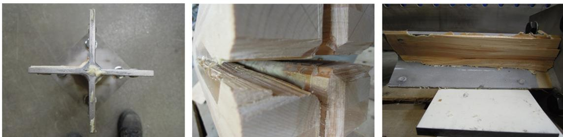
Abbildung 5.33: Bilder des Versagens des Prüfkörpers T002\_3 durch Versagen der Klebstofffuge
