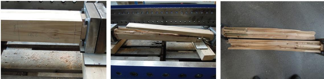
Abbildung 5.20: Bilder des Versagens des Prüfkörpers T004\_1 durch Aufspalten
