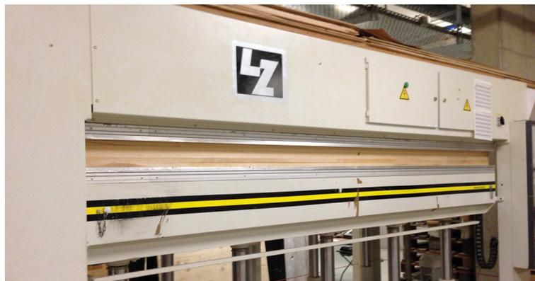
Abbildung 4.1: Pressvorgang der Birken-Brettschichtholzträger
