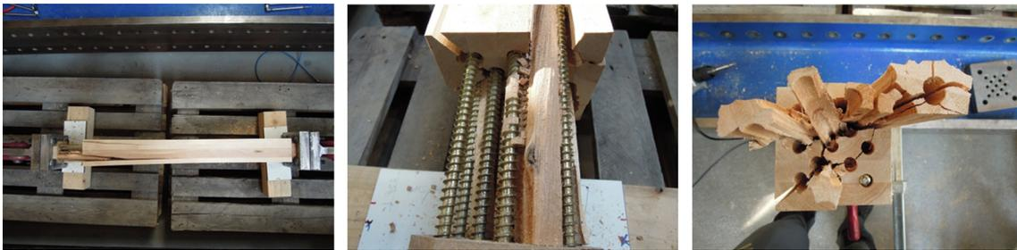
Abbildung 5.16: Bilder des Versagens des Prüfkörpers T001\_1 durch Aufspalten
