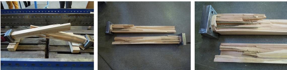
Abbildung 5.10: Bilder des Versagens des Prüfkörpers T005\_2 durch Aufspalten
