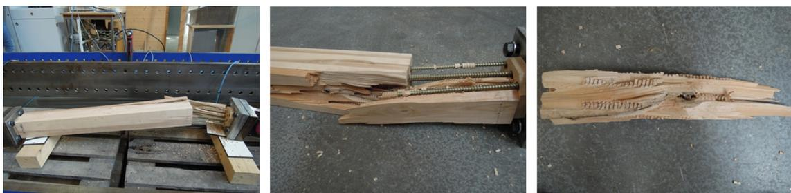
Abbildung 5.14: Bilder des Versagens des Prüfkörpers T002\_1 durch Aufspalten
