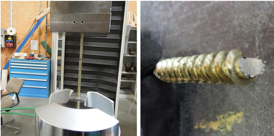
Abbildung 4.14: Fotografie einer durchgeführten Prüfung (links) und eines Bruchbildes einer Schraube (rechts)
