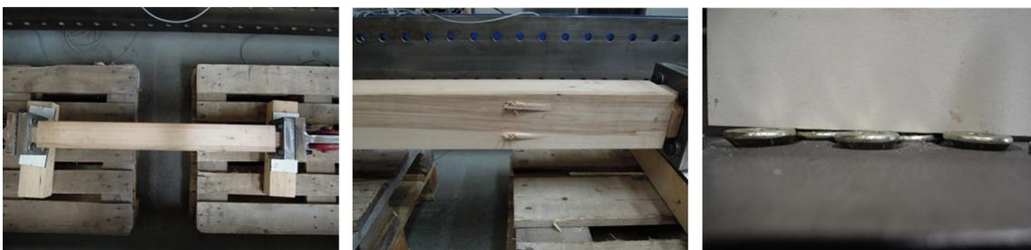
Abbildung 5.29: Bilder des Versagens des Prüfkörpers T002\_2 durch Herausziehen der Schrauben (Prüfung 8.2)
