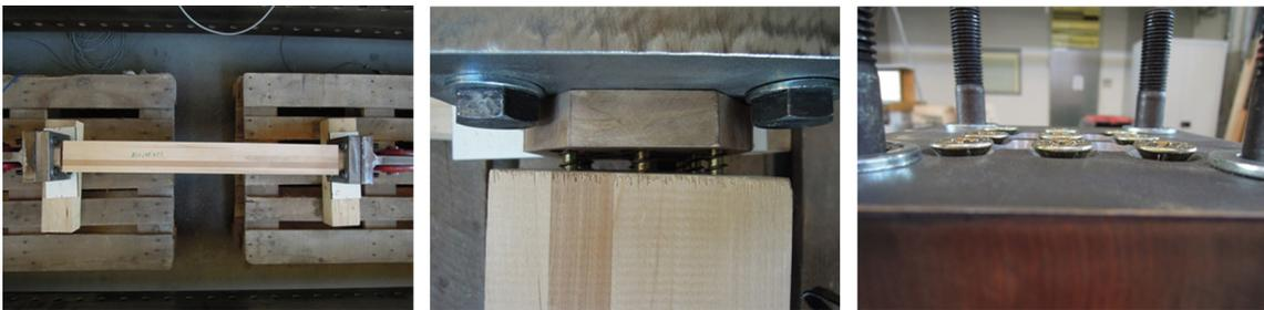
Abbildung 5.22: Bilder des Versagens des Prüfkörpers T001\_2 durch Herausziehen der Schrauben
