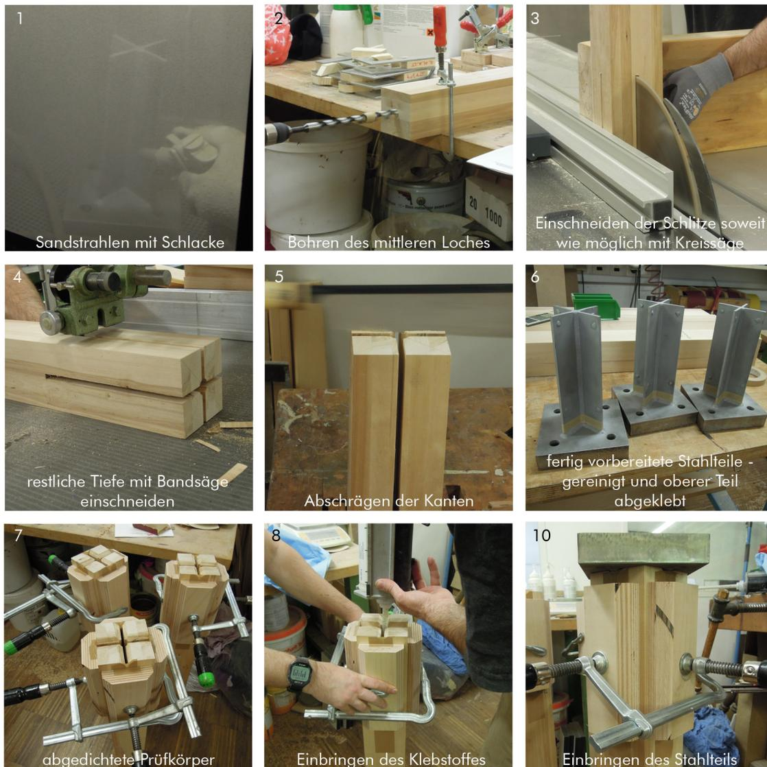
Abbildung 4.25: Ablauf der Prüfkörpervorbereitung
