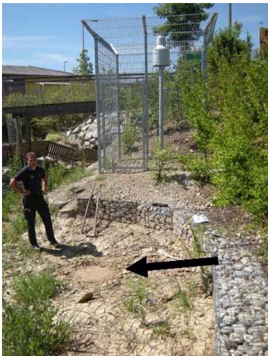
Abbildung 30: Pegelmessschacht links und Luftperlsensor rechts (Stadt Graz, 2010)
