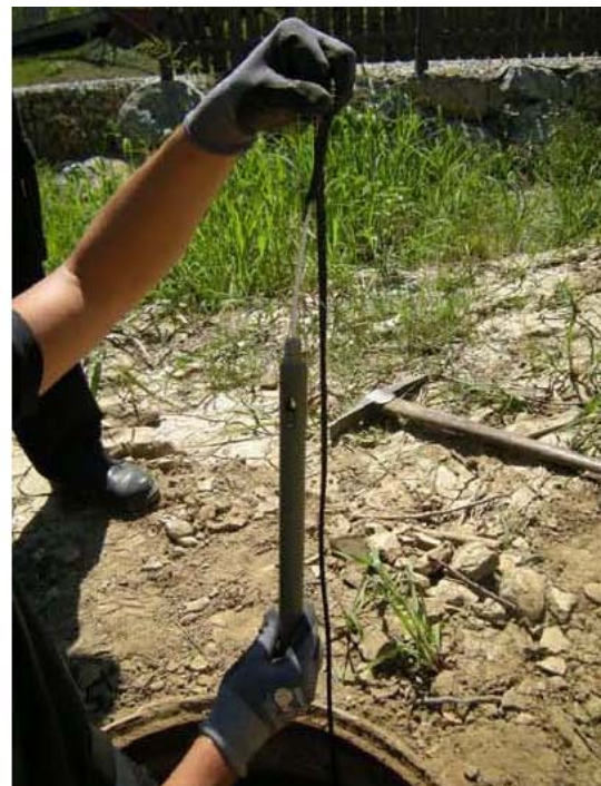
Abbildung 30: Pegelmessschacht links und Luftperlsensor rechts (Stadt Graz, 2010)
