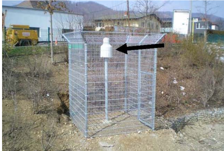
Abbildung 31: Niederschlagsmesseinrichtung (Stadt Graz, 2010)
