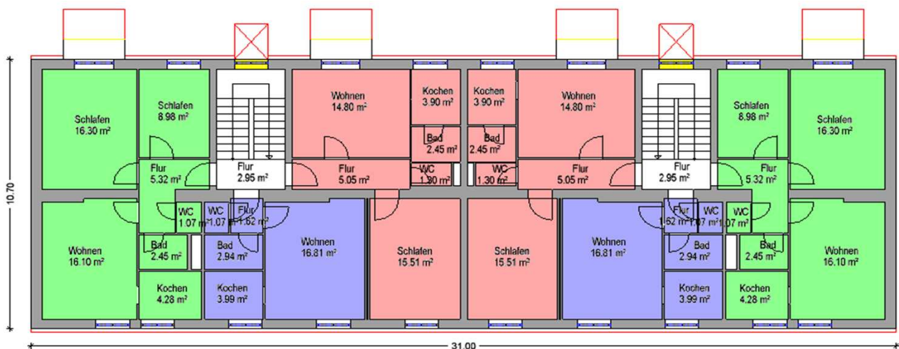
Grundriss Regelgeschoss nach Sanierung
