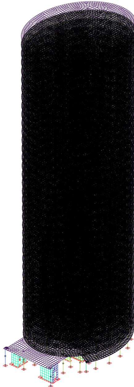
LF 2: Belastung, Eigengewicht Fußbodenaufbau 1,7 KN/m<sup>2</sup>
