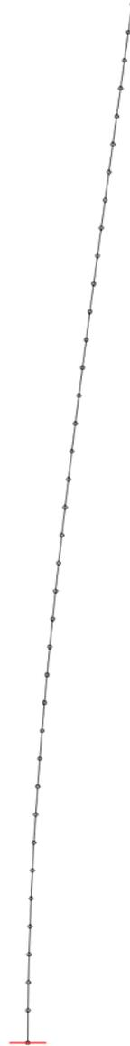
Eigenform 2: Eigenfrequenz = 0,45 Hz, Deformationen u [mm], Faktor = 1797,4
