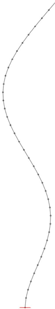
Eigenform 5: Eigenfrequenz = 7,48 Hz, Deformationen u [mm], Faktor = 1937,6
