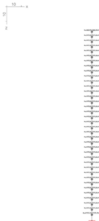
Abbildung 6-1 Konzentrierte Punktmassen in der Höhe der Geschossdecken
