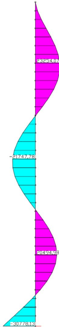
LF 17: Erdbebenkräfte in y-Richtung aus EF7
