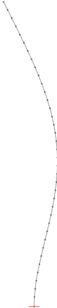
Eigenform 3: Eigenfrequenz = 2,67 Hz, Deformationen u [mm], Faktor = 1868,6
