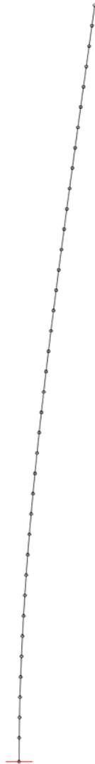
Eigenform 1: Eigenfrequenz = 0,43 Hz, Deformationen u [mm], Faktor = 1797,4
