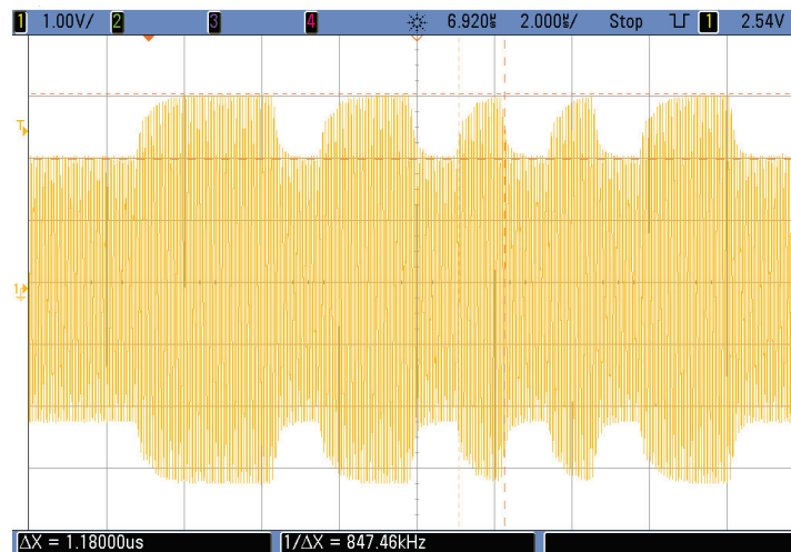
Abbildung 5.39: Signalverlauf einer Typ-B Kommunikation mit einer Datenrate von 848 kbit/s
