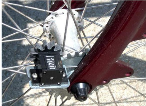
Abbildung 2.1: **Jones-Counter.** Bei dem schwarzen Kästchen handelt es sich um den Jones-Counter, der mit Hilfe des Zahnradgetriebes die Radumdrehungen zählt. (Bild: Riegel 2008)
