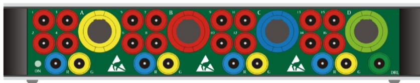
Abbildung 2.11: Vorderseite des g.USBamp mit allen Buchsen und Leuchtdioden [18]
