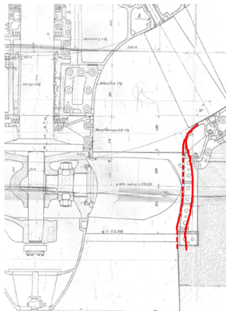
Abbildung 8.1.: Kontur des alten Halbkugel- (strichliert) und neuen Vollkugelmantels (durchgezogen).
