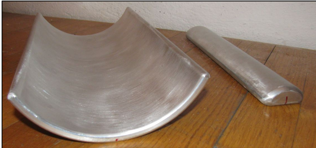
Abbildung 28: Erdelektrode und Hochspannungselektrode der optimierten Anordnung
