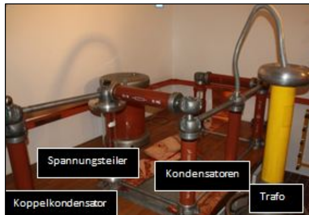
Abbildung 15: Aufbau der 100kV-Schaltung
