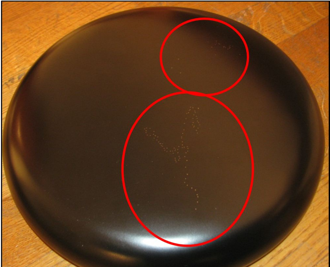
Abbildung 40: Überschreiten der Durchschlagfestigkeit des SF 6 -Gases bei einer Platte-Platte-Anordnung, bevor die Abhebegeldstärke erreicht ist. Die Punkte zeigen die Durchschlagkontakte auf der Isolierschicht
