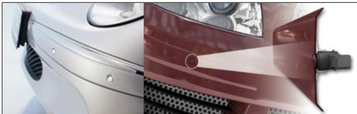
Abbildung 22: Ultraschallsensoren an der Fahrzeugfront [54, 55]
