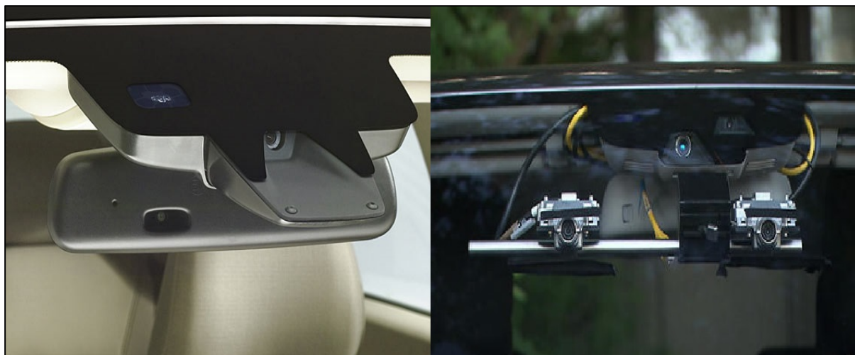
Abbildung 21: Mono- und Stereokamerasystem [66, 14]
