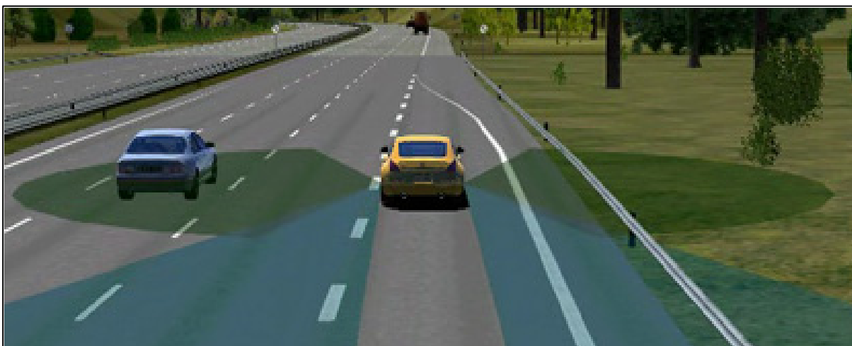
Abbildung 17: Fahrzeug mit Radarsensoren zur Seite und nach hinten [25, 2006a]
