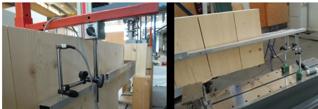
Abb. 2.15 Messung der Verdrehung, Befestigung
