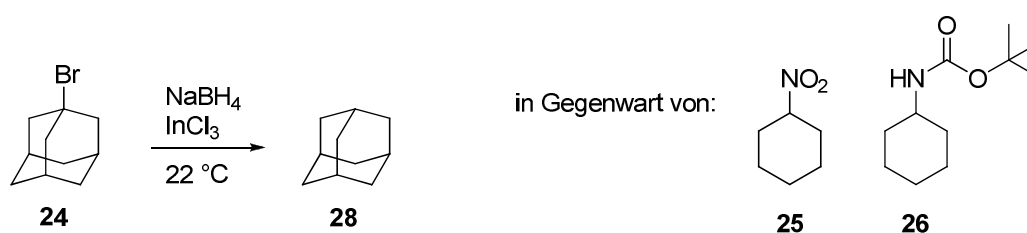
Abb. 37: Screening-Bedingungen für eine radikalische Hydrodehalogenierung mittels \text{NaBH}_4/\text{InCl}_3 [86] in Gegenwart von Nitrocyclohexan ( 25 ) und tert -Butylcyclohexylcarbamate ( 26 )
