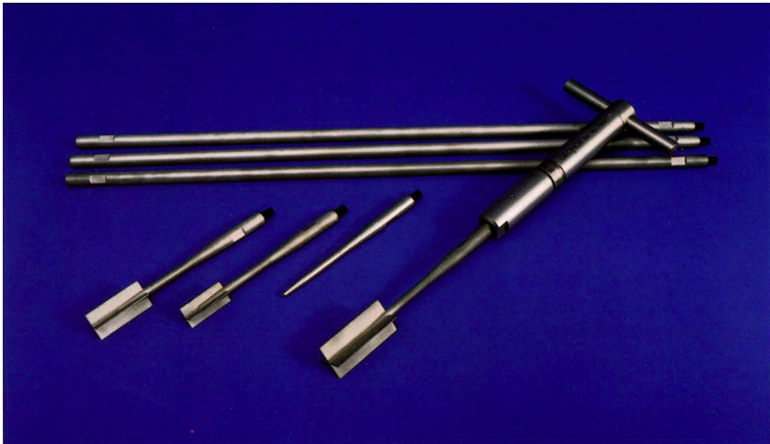
Abbildung 3.1: Drehflügelsonde H60, Fa. Geonor ( www.geonor.com )
