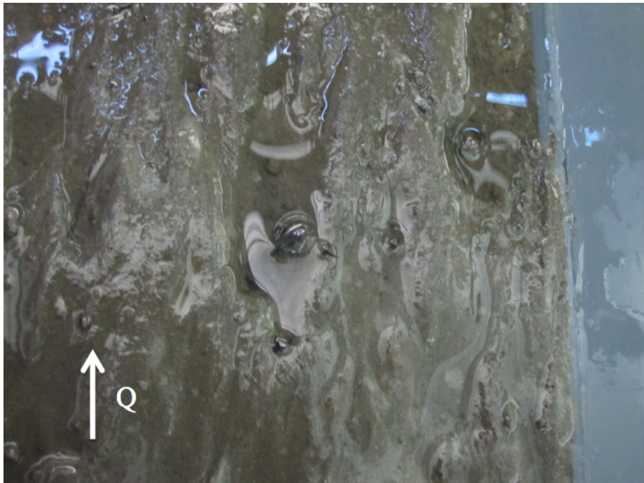
Abbildung 4.8: Erosion an gestörter Probe, Q=23 l/s, Bildbreite: 10 cm (Bild: Autor)
