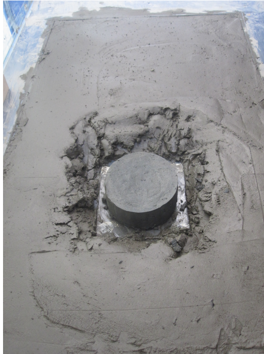
Abbildung 4.6: Blick auf die Box im Gerinne, Einbau der Probe (Bild: Autor)
