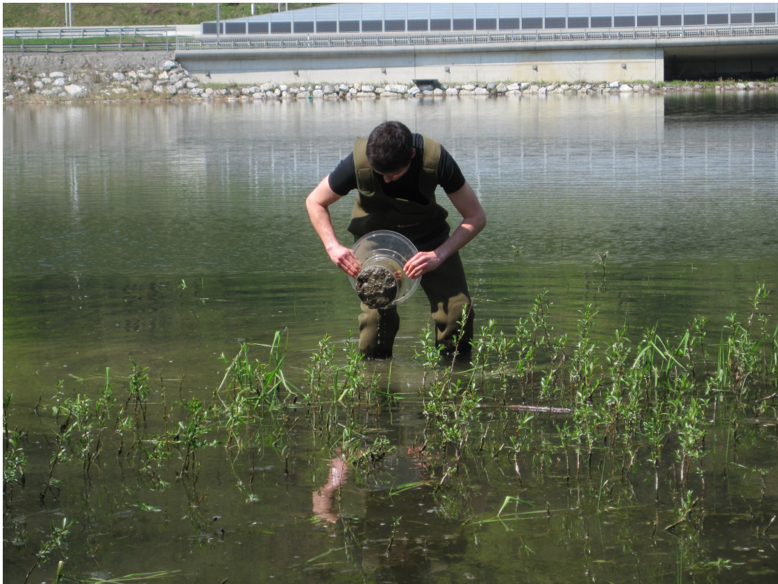
Abbildung 4.1: Entnahme der ungestörten Probe mittels Ausstechzylinders (Bild: Autor)
