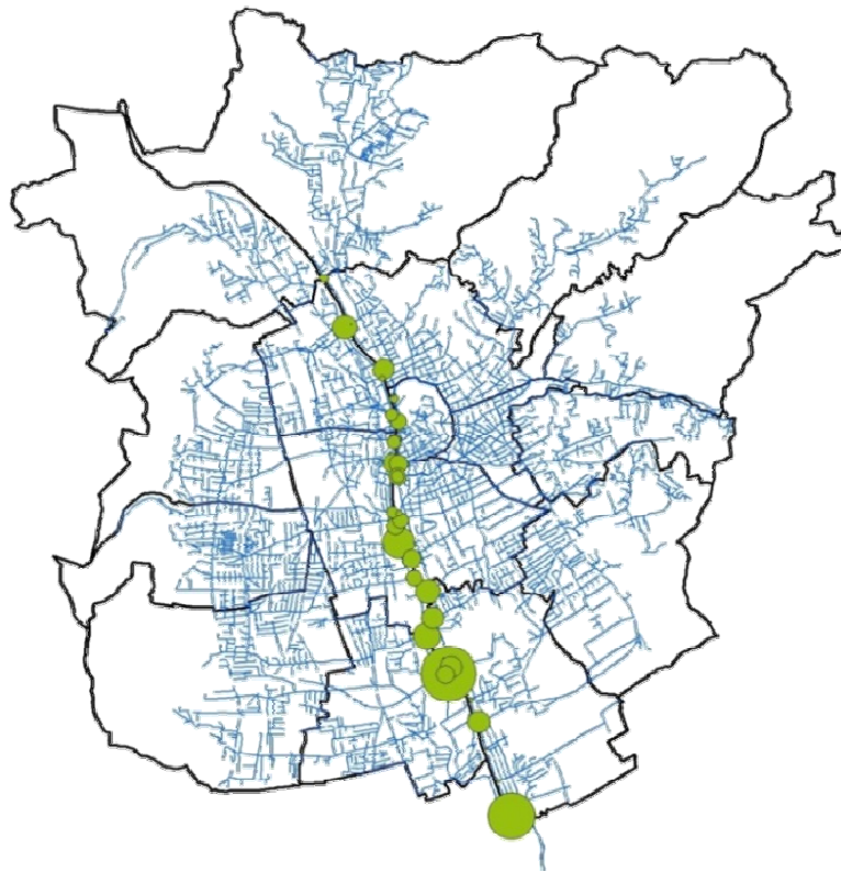
Abbildung 2-24: Mischwasserüberlaufbauwerke in die Mur (Kainz et al., 2011)
