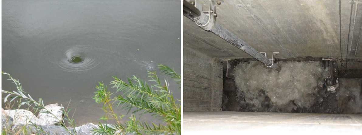
Abbildung 3-14: Saugstrudel während der Befüllung der Spülkammer (links); Einströmen der Murwassers in die Spülkammer (rechts).
