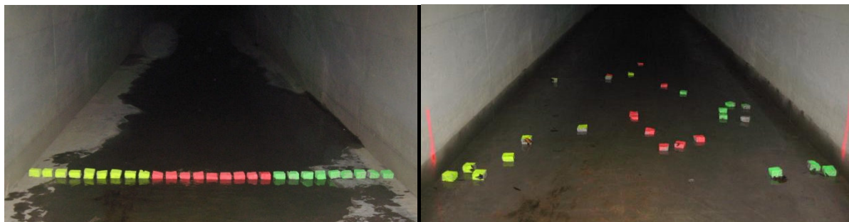
Abbildung 5-15: Einzelspülversuch XI (mit Sedimenteinträgung) am 05.12.2013 im Wehrbauwerk KS2 Position der Versuchssedimente vor / nach dem Spülversuch
