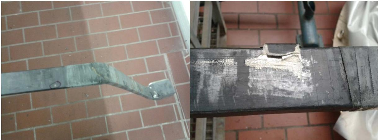
Abbildung 14: Links: Af2\_27(U) optisch gut erhaltener Stab. Rechts: Af2\_11(V) Stab mit starker Vorschädigung
