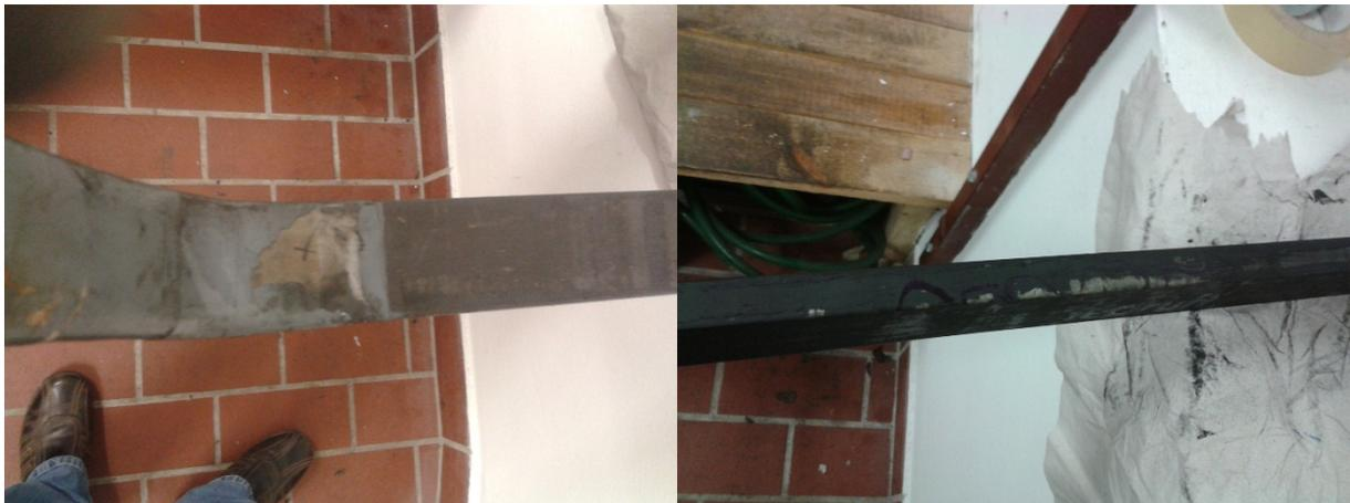
**Abbildung 15: Links: WU4\_16(U) mit abgeblätterter Endenpotentialsteuerung. Rechts: Wu4\_127(V) mit AGS – Erosion im Bereich der Stabschmalseite**
