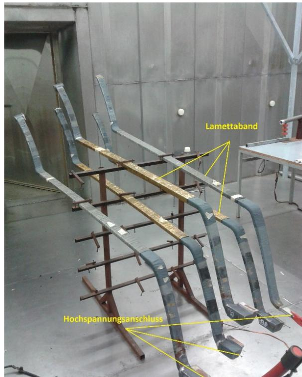
**Abbildung 10: In die Haltevorrichtung eingespannte Versuchsstäbe**
