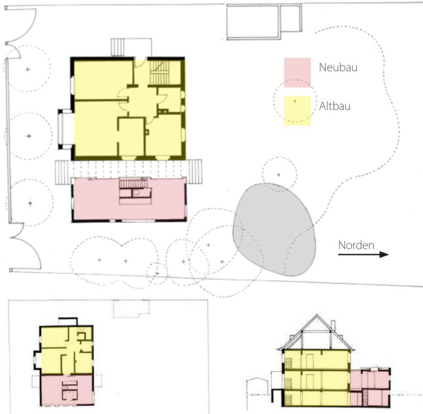
05 Grundriss Erdgeschoss (oben), Untergeschoss (unten) und Gebäudeschnitt
