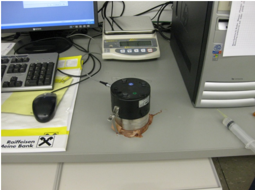
Abbildung 6.19: Verkehrt aufgesetzter Messkopf mit Stechzylinder
