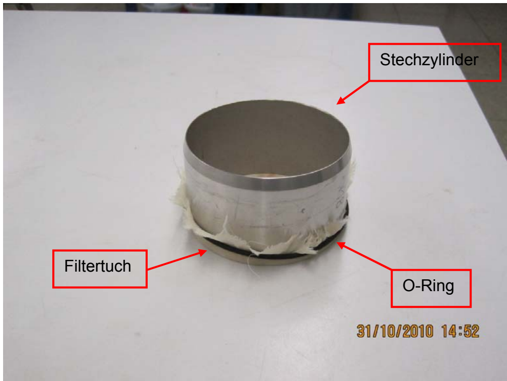
Abbildung 6.5: Stechzylinder mit Filtertuch und O-Ring
