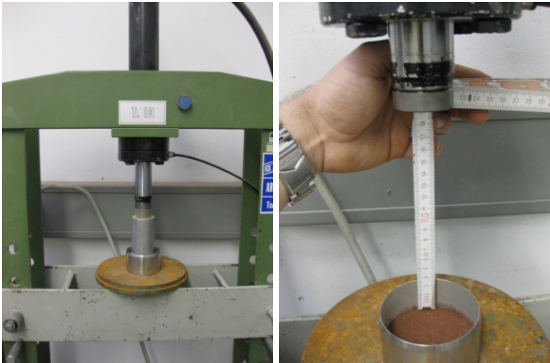
Abbildung 6.3: Einpressvorgang und Kontrolle des Absetzmaßes
