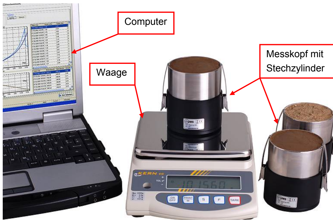
Abbildung 5.4: Das HYPROP-System zur Bestimmung von hydraulischen Bodeneigenschaften (Fa. UMS, 2010)
