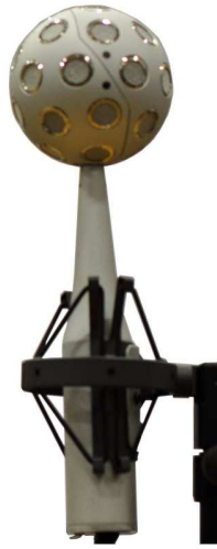
Abbildung 2.4: Kugelförmiges Mikrofonarray, Eigenmike.
