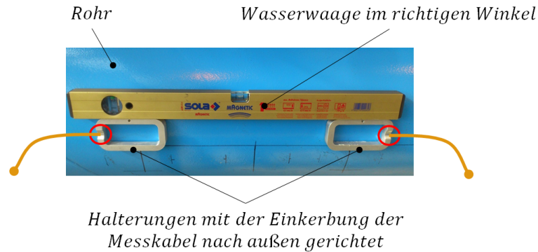
Abbildung A.8.: Ausrichten der Sensorhalterungen am Rohr.
