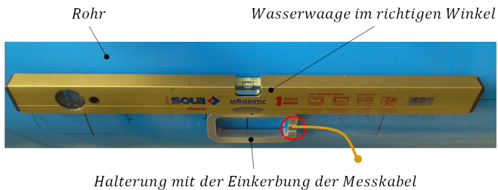
Abbildung A.4.: Abgleich der Montagewinkel am Rohr.
