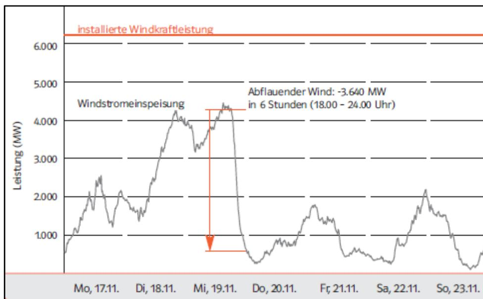
Abbildung 3.6: Windkraftschwankungen (E.ON-Regelzone 17-23.11.2003)<sup>20</sup>
