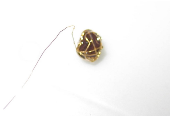
Abbildung 3.2: Fotografie eines mit Golddraht umwickelten porösen Pellets.
