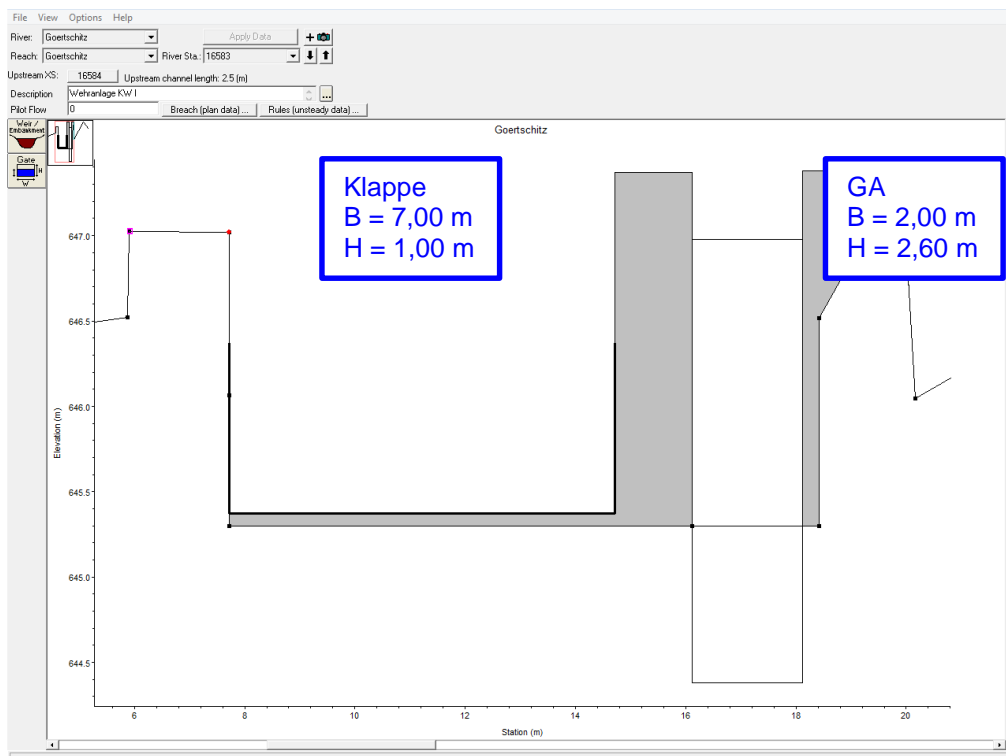
Abbildung 4.22: Wehranlage KW I HEC-RAS Modellierung
