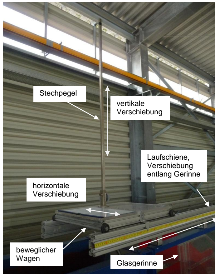
Abbildung 13: Messeinrichtung auf Stechpegel auf verschieblichen Wagen
