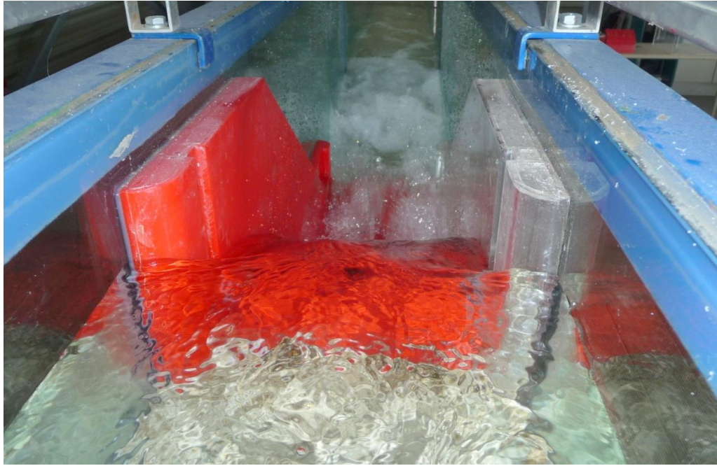
Abbildung 34: Wehrüberfall bei Z_2=29,95 l/s
