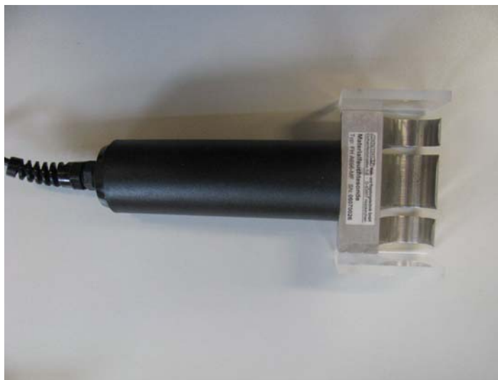
Abb. 1.13 Materialfeuchtesensor basierend auf einer kapazitiven Messung
