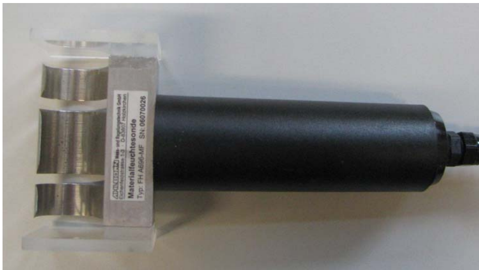
Abb. 1.38 Materialfeuchtegeber basierend auf kapazitiven Messverfahren
