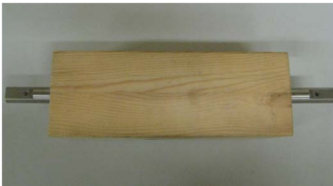
Abb. 1.26 Invarstab zur Kalibrierung des Messschiebers
