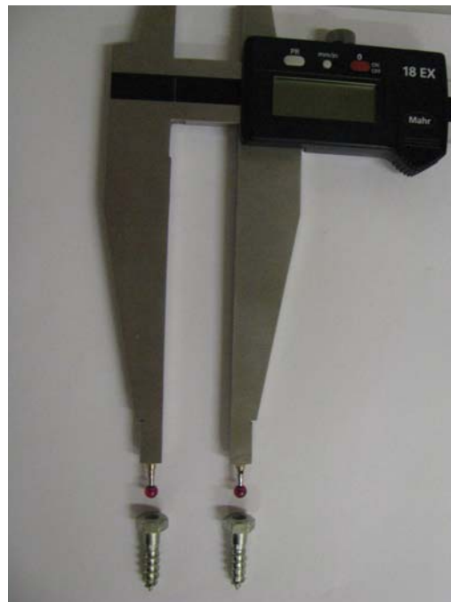
Abb. 1.24 Messschieber mit kugelförmigen Messrubinen und passenden Schrauben
