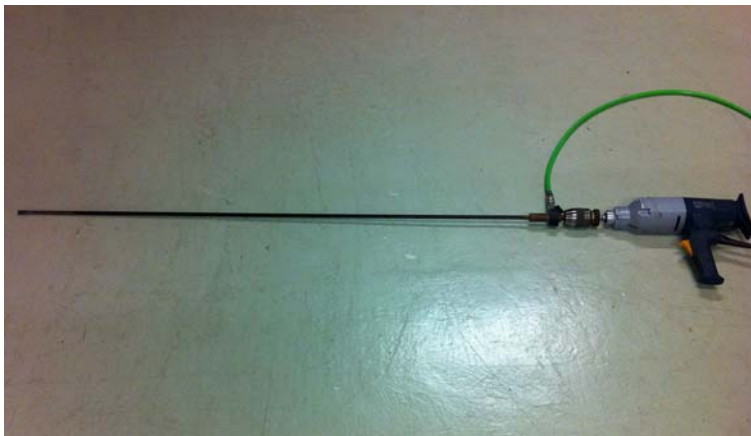
Abb. 1.20 Bohrmaschine mit 1500 mm langen druckluftgespültem Tieflochbohrer
