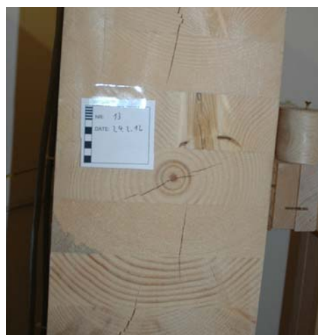
Abb. 1.32 Rissbildung Prüfkörper 13 nach 4 Tagen
