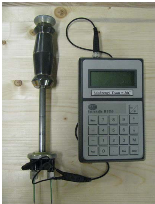
Abb. 1.11 Holzfeuchtemessgerät basierend auf elektrischer Widerstandsmessung
