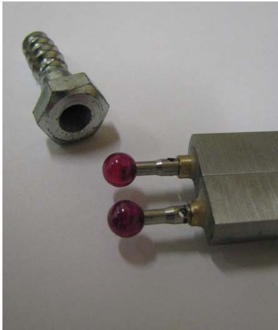
Abb. 1.25 kugelförmige Messrubine mit passender Sechskant-Holzschraube
