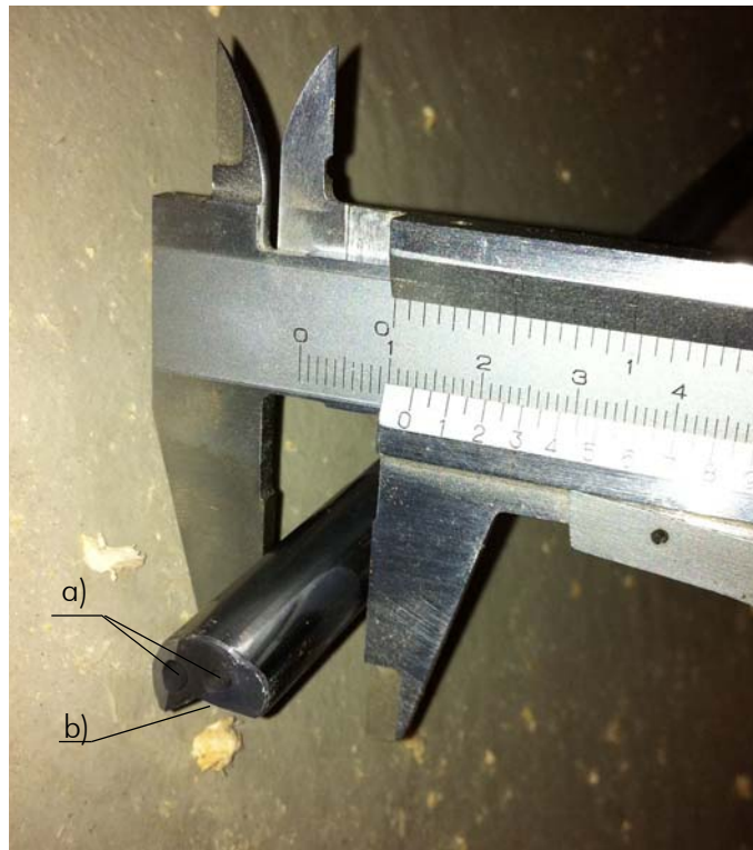
Abb. 1.21 Bohrer a) Luftlöcher b) Nut zum Abtransportieren der Späne
