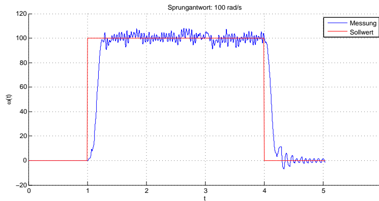
Abbildung 11.31: Sprungantwort des Sub-Optimal Algorithm bei 100 \frac{\text{rad}}{\text{s}} Sollwert.
