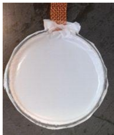
Abbildung 26: Verschweißter Separator zugeschnitten.
