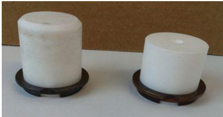
Abbildung 24: Werkzeug zum Verschweißen des Separators (rechts: größerer Ring, links: kleinerer Ring).
