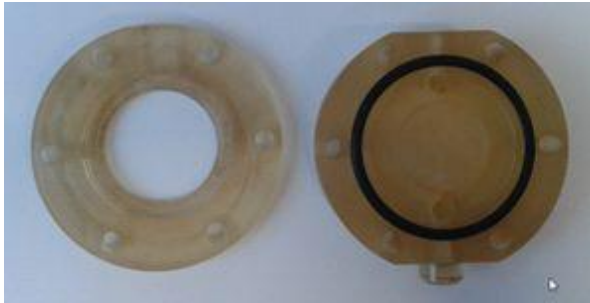
Abbildung 32: Bausatz I - Anodenhalterung ohne Dichtung abgebildet.
