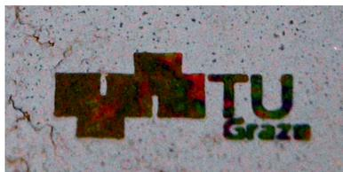
**Abb. 31:** TU Graz Logo, erhalten durch Photolithographie mittels PHA-basierenden Negativresist.
