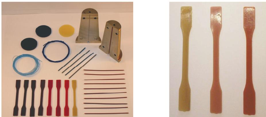
**Abb. 11:** Spritzgegossene Formkörper und offene Form (*links*); spritzgegossene Schulterprüfkörper für den Zugversuch (*rechts*).
