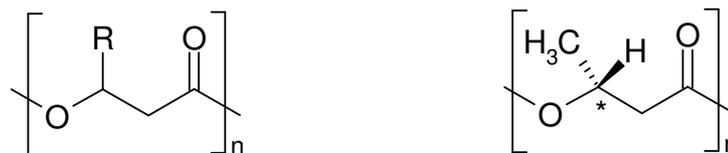
**Schema 2:** Allgemeine chemische Struktur von Poly(3-hydroxyalkanoat)en PHAs (*links*) und Poly(3-hydroxybutyrat) PHB (*rechts*). Die Monomere haben ein chirales Zentrum in (R)-Konfiguration.
