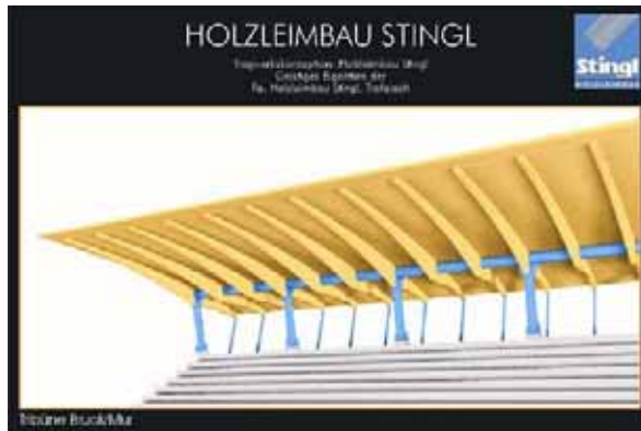
Abb. B1.12 Mittelrippen, 2-teilige Randrippen mit 3-schichtigem BSP-Aufbau, Rohr als Überzugträger (Quelle: H. Stingl)
