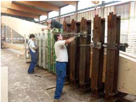
Abb. B3.13 Ansetzen der Pressen (links) und Spindelpressen zu je 7 to Presskraft (rechts). (Quelle: H. Stingl)
