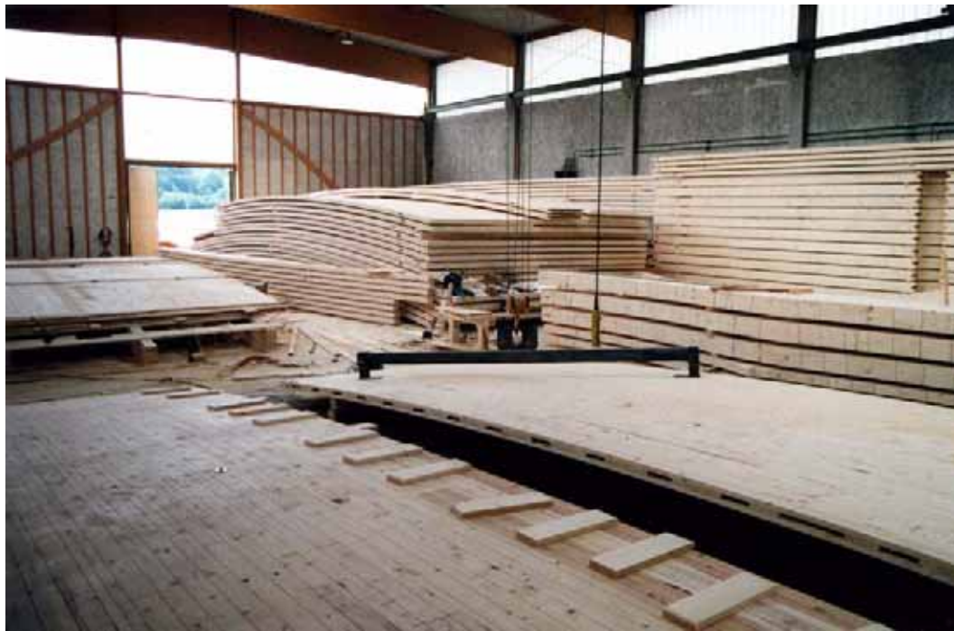
Abb. A2.4 Gekrümmte Brettsperrholzplatten vor der Weiterverarbeitung zusammen mit BSH (Quelle: Stingl Holzleimbau)
