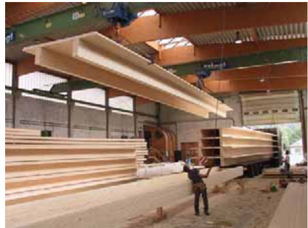
Abb. B1.2 Unionbad in Graz: Arch. DI W. Kampits / Prof. DI Dr. H. Gamerith, Graz. Statik Massivbau: DI Kager, Ziv.-Ing.-Büro Eisner, Graz. Statik Holzkonstruktion: H. Stingl, Trofaiach. Pendelwände aus BSH-Rippen mit aufgeleimten BSP-Platten. Dachtragwerk aus BSH-BSP-Elementen (Pi). (Quelle: W. Kampits)
