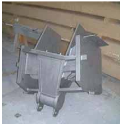
Abb. B2.10 Auflagerstahlteil vor der Montag an den Binder im Werk (Foto: WIEHAG)
