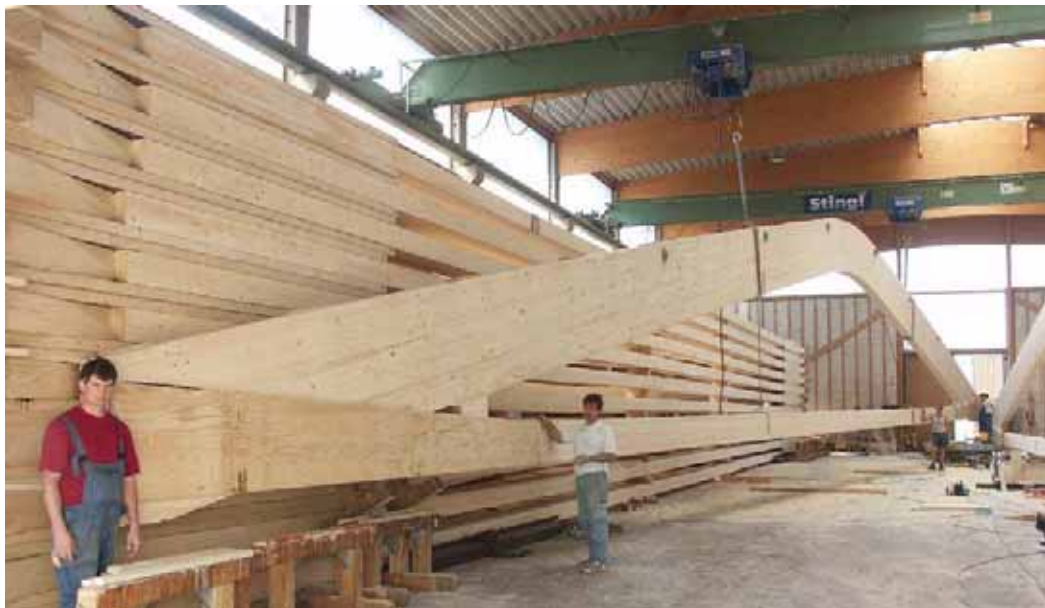
Abb. B3.11 Transportfertiger Binder mit allen vormontierten Stahl-Verbindungsteilen (Quelle: H. Stingl)
