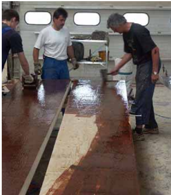
Abb. B3.12 Manueller Leimauftrag Dynosol S 204 (Quelle: H. Stingl)
