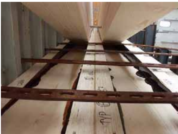
Abb. B3.14 Presspaket aus drei Bindern (links) und BSH-Querschnitte mit Kerto-Platten; Leimaustritt als Kontrolle des Leimauftrages (rechts). (Quelle: H. Stingl)
