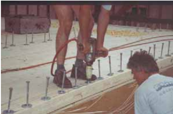
Abb. B1.20 Verleimung und Verpressung von BSP mit BSH im Werk (Quelle: H. Stingl)
