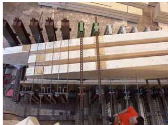
Abb. B3.14 Presspaket aus drei Bindern (links) und BSH-Querschnitte mit Kerto-Platten; Leimaustritt als Kontrolle des Leimauftrages (rechts). (Quelle: H. Stingl)
