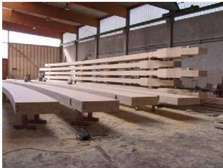
Abb. A1.3 BSH- Rohlinge nach dem Abbund, hier blockverleimt (Quelle: Stingl Holzleimbau)
