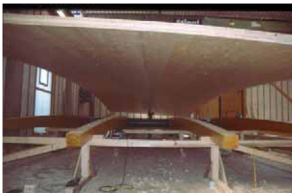
Abb. B1.19 Abbund und Vorbereitung zur Verleimung im Werk (Quelle: H. Stingl)
