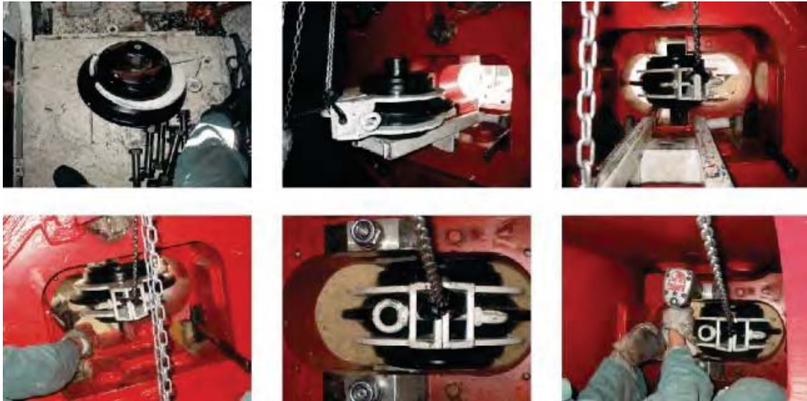
Abbildung 3.22: Wechsel eines Rollenmeissels am Schneidrad einer TVM 30
