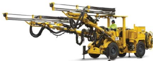
Abbildung 3.12: Bohrwagen Atlas Copco Boomer 282 mit 2 Bohrlafetten 15
