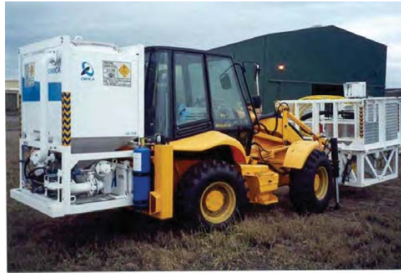
Abbildung 3.14: Mischlade Fahrzeug der Fa. Orica (ehem. Dynamit Nobel) zum Einbringen pumpbarer Emulsionsprengstoffe 18
