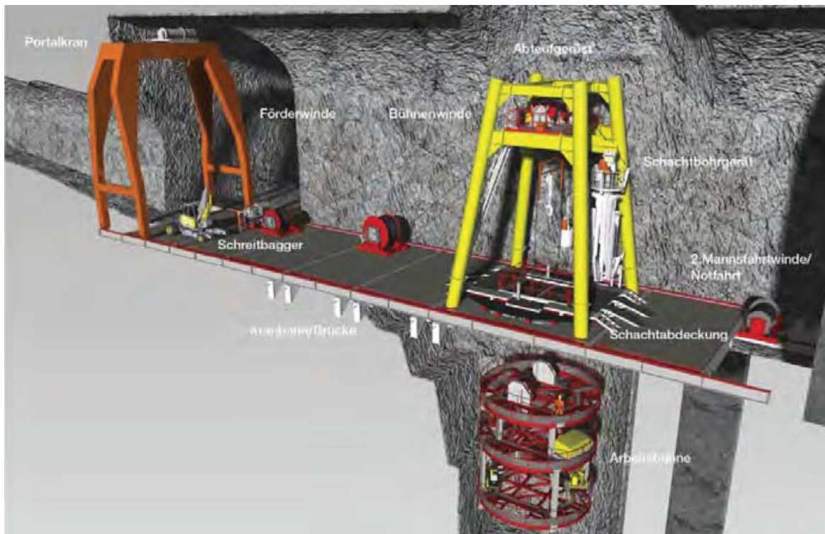
Abbildung 4.12: Einrichtungen zur sprengtechnischen Erweiterung des Pilotschachtes mit mehreren unabhängigen Winden und einer mehrstöckigen Arbeitsbühne 24
