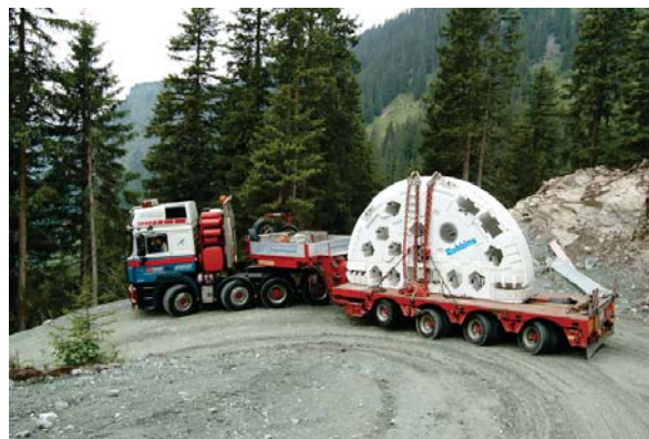
Abbildung 3.23: Transport einer Hälfte des Schneirades der DSM zum Auffahren des Druckstollens für das PSW Kops II 31
