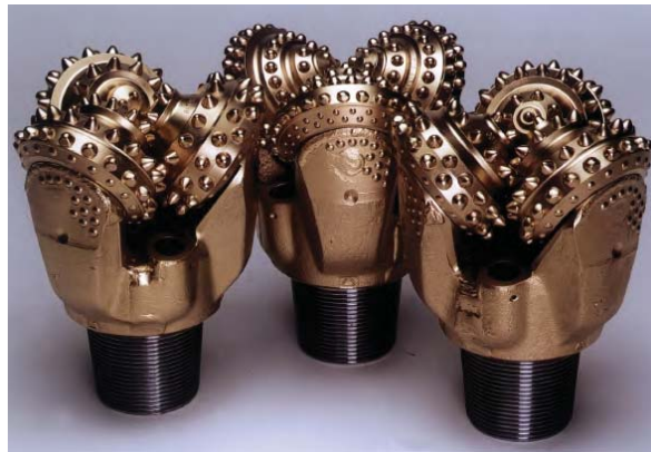
Abbildung 3.44: Pilotbohrkronen der Firma Sandvik (Durchmesser 9-15 Zoll) 61
