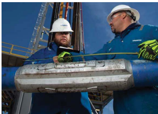
Abbildung 3.45: Roller Reamer der Firma Schlumberger zur Stabilisierung des Bohrstrangs und Sicherung der Maßhaltigkeit des Bohrdurchmessers 62
