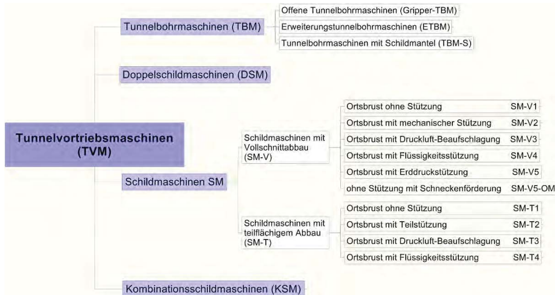
Abbildung 3.20: Einteilung von Tunnelvortriebsmaschinen 27
