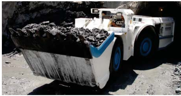
Abbildung 3.18: Fahrlader der Firma GHH zur Schutterung und dem Transport von Ausbruchsmaterial 23
