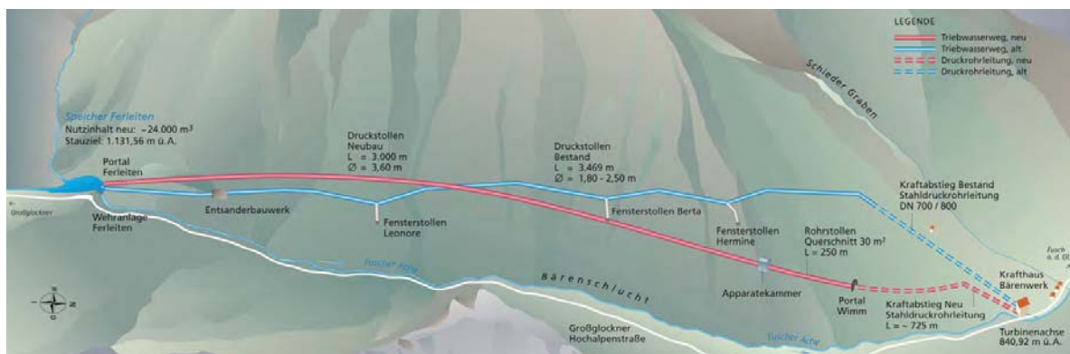
Abbildung 1.16: Triebwasserführung KW Bärenwerk (Fusch / Salzburg) 35)
