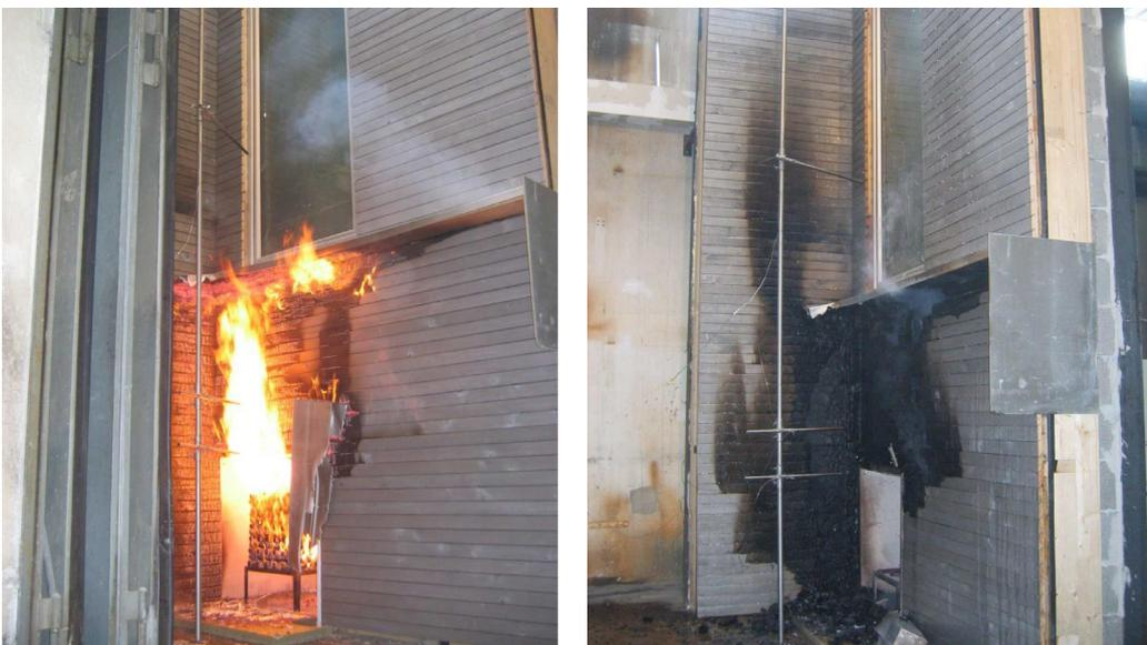
Abb. 2.5 Während und nach der Beflammung, aus [40]
