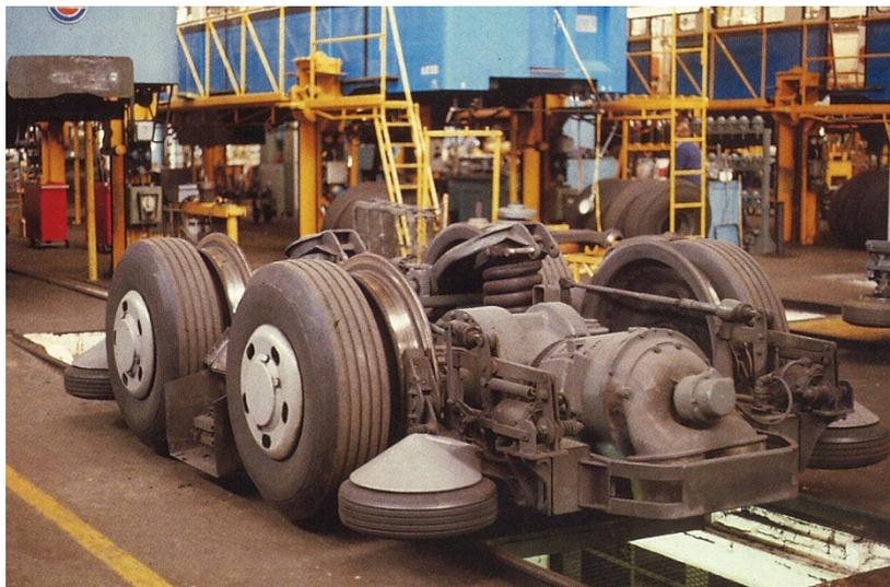
Abbildung 54: Drehgestell eines gummibereitigen Fahrzeuges [23]
