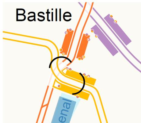
Abbildung 7: Linie 1 – Engste Kurve des Netzes bei *Bastille* mit einem Radius von 40 m [27]
