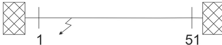
Abbildung 9-19: Zweiseitig gespeiste Leitung, Fehler am Mast Nr. 3
