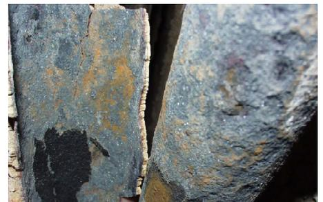
Abbildung 2-22 Hochtemperaturkorrosion Überhitzerrohr [28]
