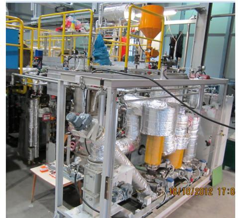
Abbildung 3-17 Prüfstand zur gestuften Biomassevergasung
