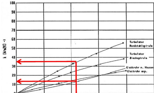
Abbildung 3-13 k-Wert Wärmetauscherrohren [34];
