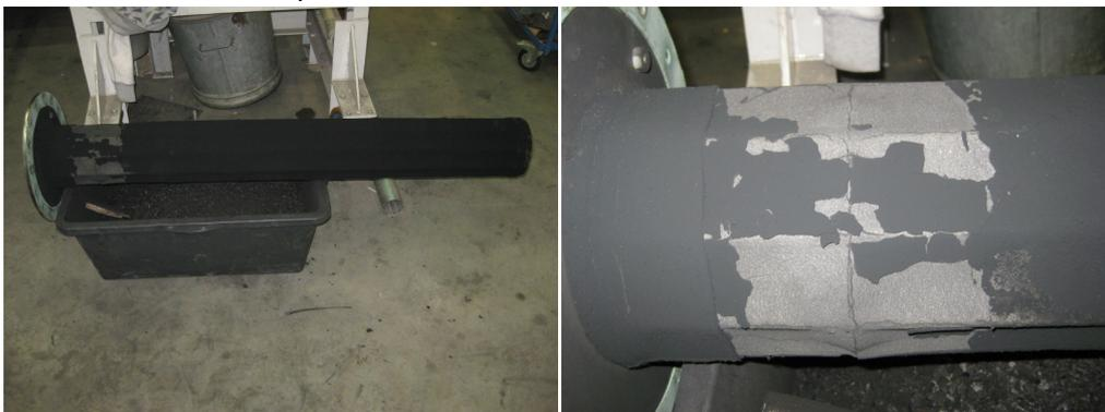
Abbildung 5-10 Inspektion IBN-Vers.2 Schlauchfilter
