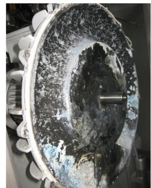
Abbildung 3-9 Korrosion "altes" PG-Gebläse nach ca. 300 Bh
