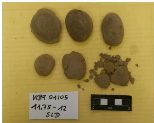
Abb.12: Probe KBF 01/05 11,75-12m mit „völlig zerfallenem“ Zerfallsgrad; linke Seite: Probe vor Versuchsbeginn; rechte Seite: Probe nach Versuchsende (Versuchsabbruch nach 3.Zyklus aufgrund eines Masseverlustes >70%);
