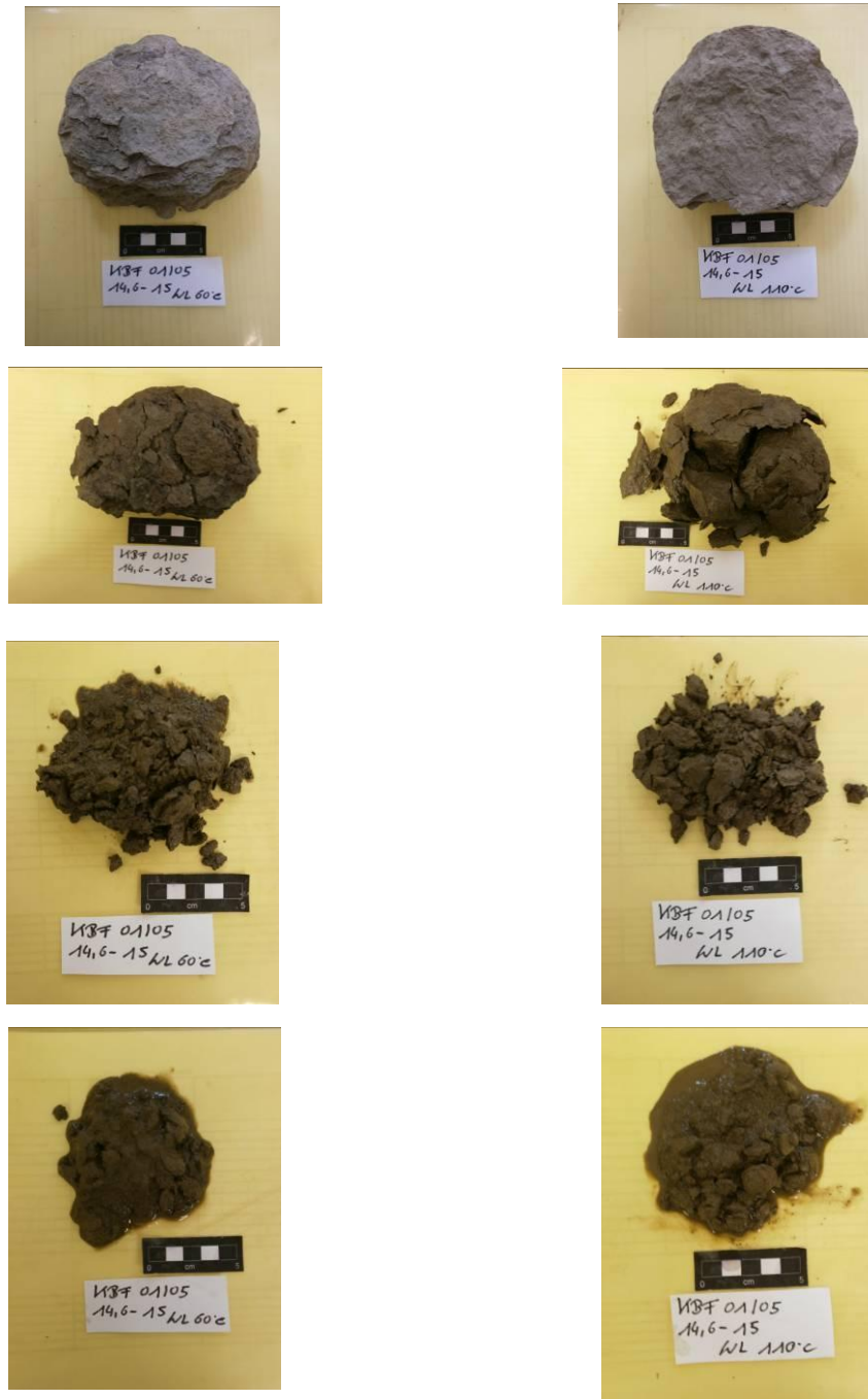
Abb.8: Konstante Veränderlichkeit der Probe KBF 01/05 14,6-15m bei durchgeführten Trocknungs-Befeuchtungs-Wechsel bei 60°C & 110°C Trocknungstemperatur; linke Seite: Konstante Veränderlichkeit von oben nach unten bei einer Trocknungstemperatur von 60°C; rechte Seite: Konstante Veränderlichkeit von oben nach unten bei einer Trocknungstemperatur von 110°C;
