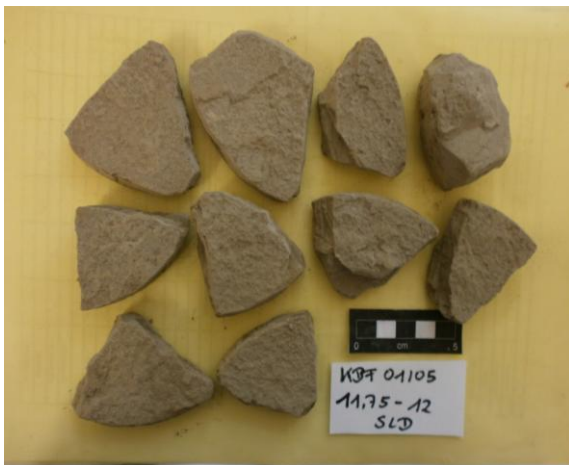
Abb.12: Probe KBF 01/05 11,75-12m mit „völlig zerfallenem“ Zerfallsgrad; linke Seite: Probe vor Versuchsbeginn; rechte Seite: Probe nach Versuchsende (Versuchsabbruch nach 3.Zyklus aufgrund eines Masseverlustes >70%);
