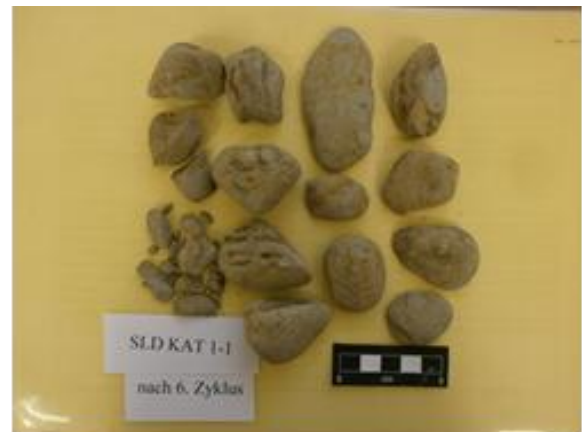
Abb.23: Probe KAT 1-1 mit „teilweise zerfallenem“ Zerfallsgrad; linke Seite: Probe vor Versuchsbeginn; rechte Seite: Probe nach Versuchsende (6 durchlaufene Zyklen);
