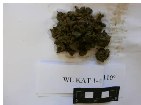
Abb.18: Zunahme der Veränderlichkeit der Probe KAT 1-4 bei durchgeführtem Trocknungs-Befeuchtungs-Wechsel bei einer Trocknungstemperatur von 110°C; linke Seite: Darstellung der Veränderlichkeit von oben nach unten bei einer Trocknungstemperatur von 60°C; rechte Seite: Darstellung der Veränderlichkeit von oben nach unten bei einer Trocknungstemperatur von 110°C;
