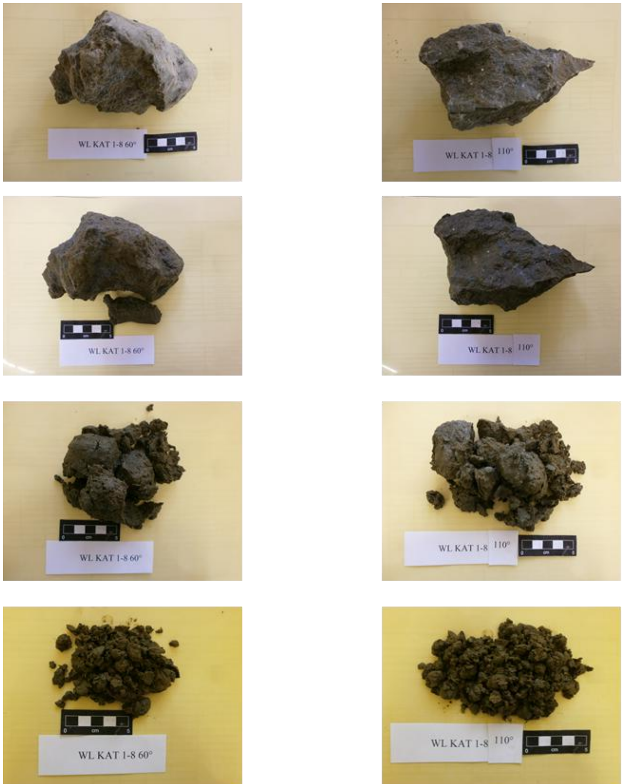
Abb.19: Konstante Veränderlichkeit der Probe KAT 1-8 bei durchgeführten Trocknungs-Befeuchtungs-Wechsel bei 60°C & 110°C Trocknungstemperatur; linke Seite: Konstante Veränderlichkeit von oben nach unten bei einer Trocknungstemperatur von 60°C; rechte Seite: Konstante Veränderlichkeit von oben nach unten bei einer Trocknungstemperatur von 110°C;
