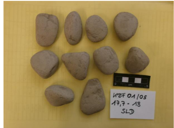
Abb.11: Probe KBF 01/05 17,7-18m mit „abgerundetem“ Zerfallsgrad; linke Seite: Probe vor Versuchsbeginn; rechte Seite: Probe nach Versuchsende (6 durchlaufene Zyklen);
