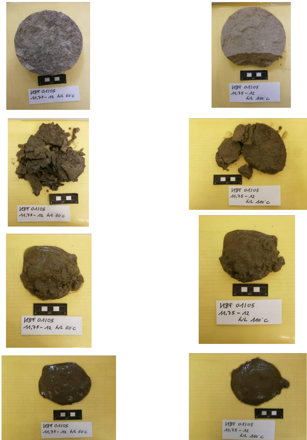
Abb.7: Zunahme der Veränderlichkeit der Probe KBF 01/05 11,75-12m bei durchgeführtem Trocknungs-Befeuchtungs-Wechsel bei einer Trocknungstemperatur von 110°C; linke Seite: Darstellung der Veränderlichkeit von oben nach unten bei einer Trocknungstemperatur von 60°C; rechte Seite: Darstellung der Veränderlichkeit von oben nach unten bei einer Trocknungstemperatur von 110°C;
