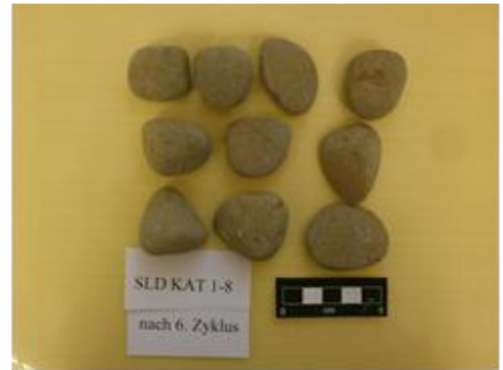
Abb.22: Probe KAT 1-8 mit „abgerundetem“ Zerfallsgrad; linke Seite: Probe vor Versuchsbeginn; rechte Seite: Probe nach Versuchsende (6 durchlaufene Zyklen);
