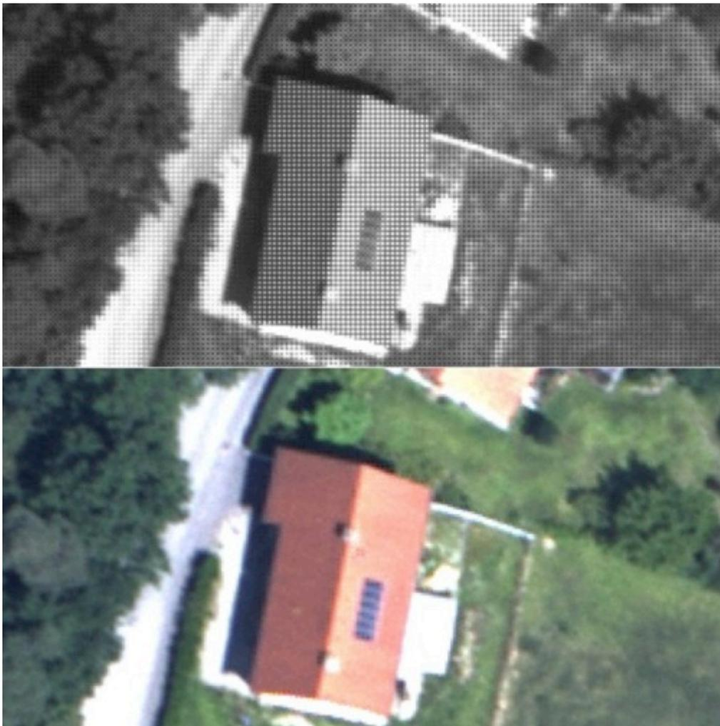
Abbildung 4.4: Oben: einkanaliges Bild mit Bayer Pattern, unten: interpoliertes RGB-Bild
