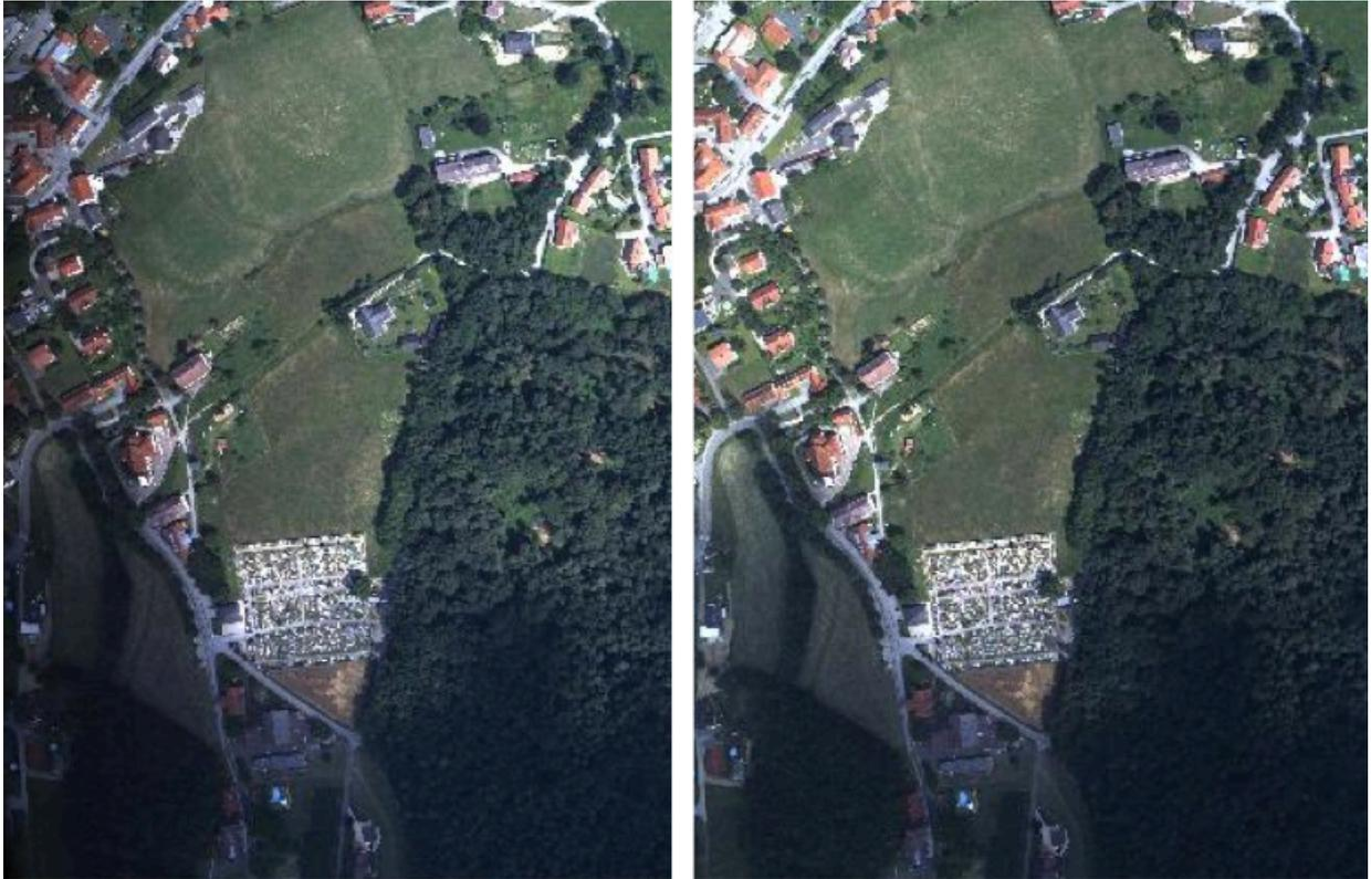
Abbildung 4.7: Einfluss der Vignettierung und der Verzeichnung, links: Originalbild, rechts: Bild mit entfernter Vignettierung und Verzeichnung
