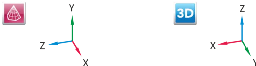
Abb. 1: Definition der Koordinatensysteme in PLAXIS 3D Foundation (links) und PLAXIS 3D (rechts)
