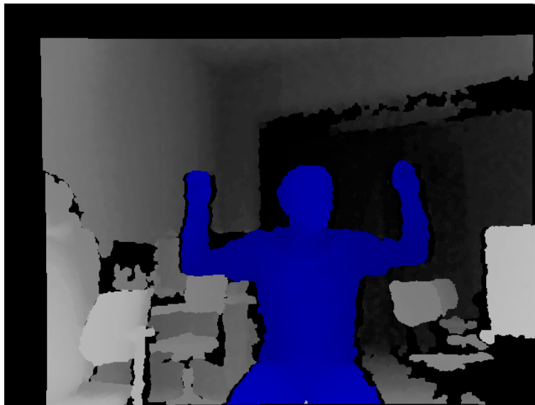
Abbildung 13: Die Abbildung zeigt ein Grauwertbild, das abhängig von den Werten des Tiefensensors eingefärbt ist. Größere Werte erzeugen eine stärkere Einfärbung. Der schwarze Bereich links und oben im Bild ergibt sich durch den Abgleich von RGB Bild und Tiefensensor Bild. Der blau eingefärbte Teil ist der Bereich der durch die Vorder-/Hintergrundsegmentierung als Benutzer erkannt wird.
