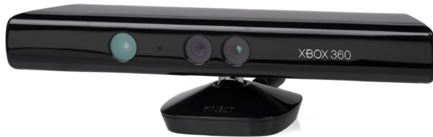
Abbildung 1: Die Abbildung zeigt den verwendeten Sensor (Microsoft Kinect) für die Messung der Szenentiefe und der Aufnahme der RGB-Bilder. Links sieht man der Infrarot Strahler für die Tiefenmessung und in der Mitte befindet sich der Empfänger. Rechts ist die RGB-Kamera montiert. (Quelle: http://caa.tuwien.ac.at/cv1/teaching/praktika/kinect/index.html )
